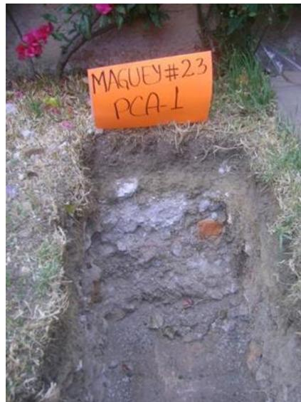
FIGURA 8. POZO A CIELO ABIERTO 1
