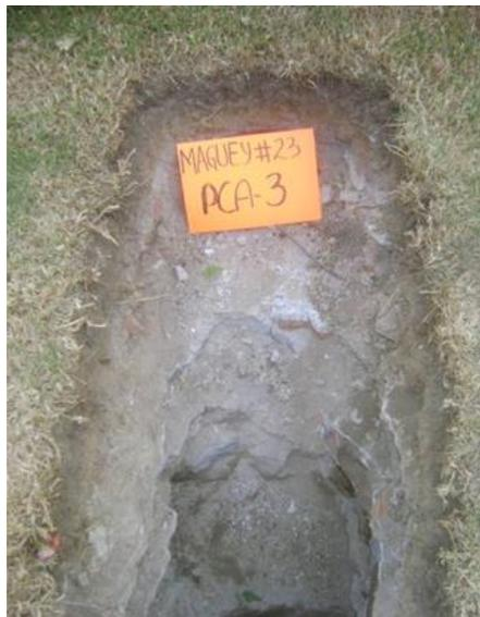
**FIGURA 10. POZO A CIELO ABIERTO 3**
