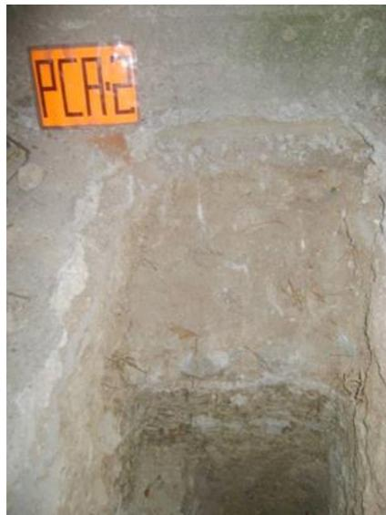
**FIGURA 9. POZO A CIELO ABIERTO 2**
