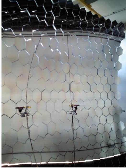
Figura 3.2: Concentrador del HoSIER compuesto por facetas hexagonales. Tomada de Licurgo-Pedraza (2012).
