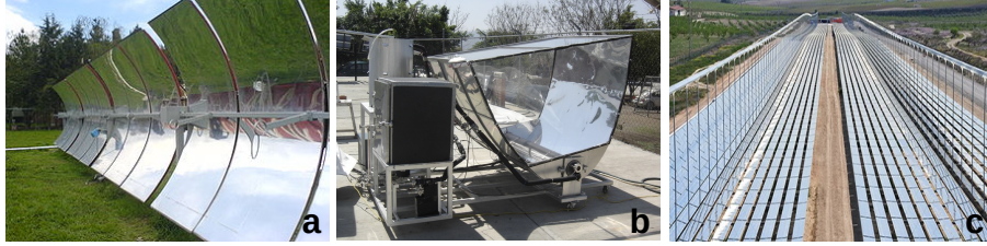
Figura 1.5: Tecnologías de concentración solar a media temperatura: a) Canal parabólico (Wikipedia 2016), b) CPC (solrenova n.d.) y c) Fresnel lineal (EcoGuard® n.d.).
