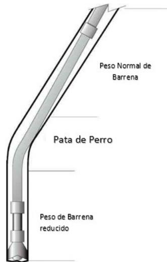
Figura 2.4.5.1: Pata de Perro causada por una súbita reducción de peso en Barrena [16]
