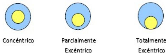
Figura 4.6.3.7: Excentricidad de tubería [5]
