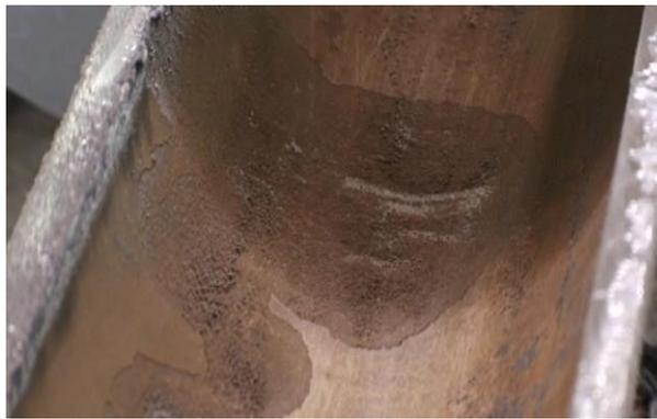
Figura 4.7.6.1: Fatiga en tubería de perforación [2]
