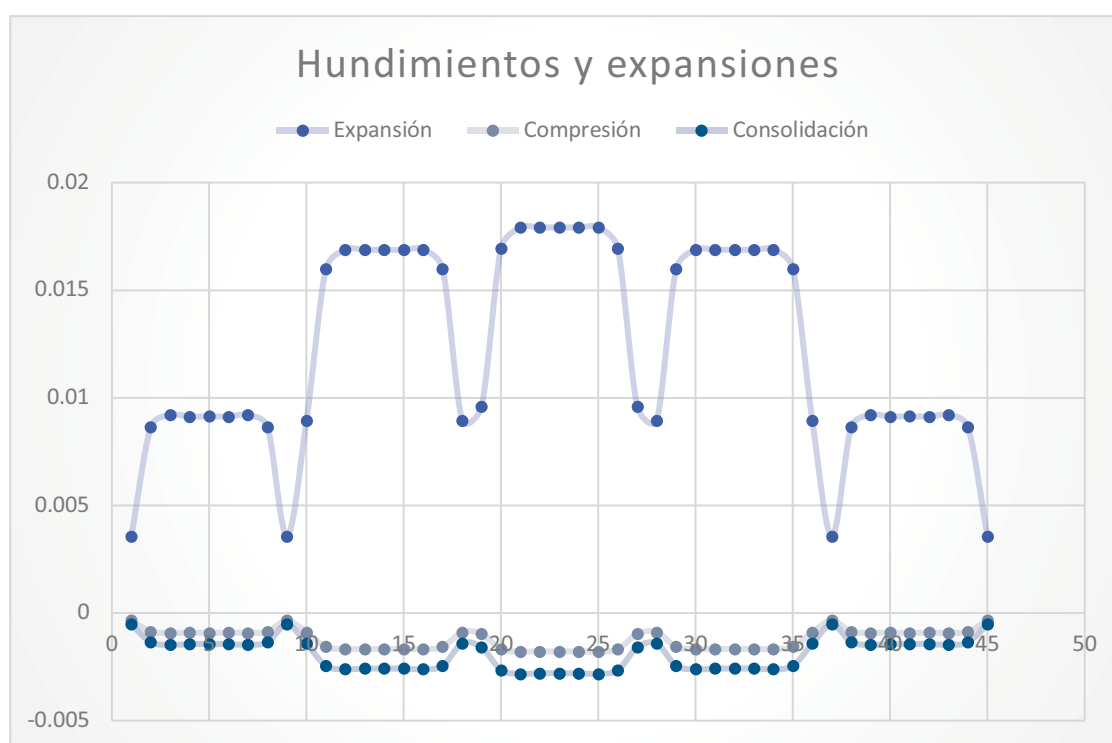
Figura 4.2.8 Hundimientos por nodo a expansión, compresión y consolidación, se observa que los mayores desplazamientos se concentran en los nodos centrales.
