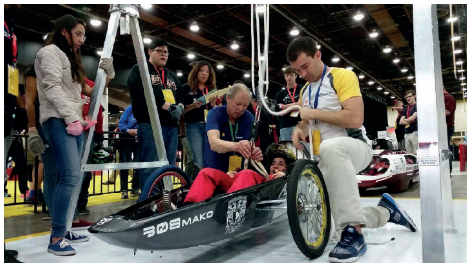
Prueba del dinamómetro para el cinturón.
