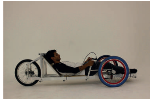
Nueva posición donde la dirección no estorba a las piernas.
