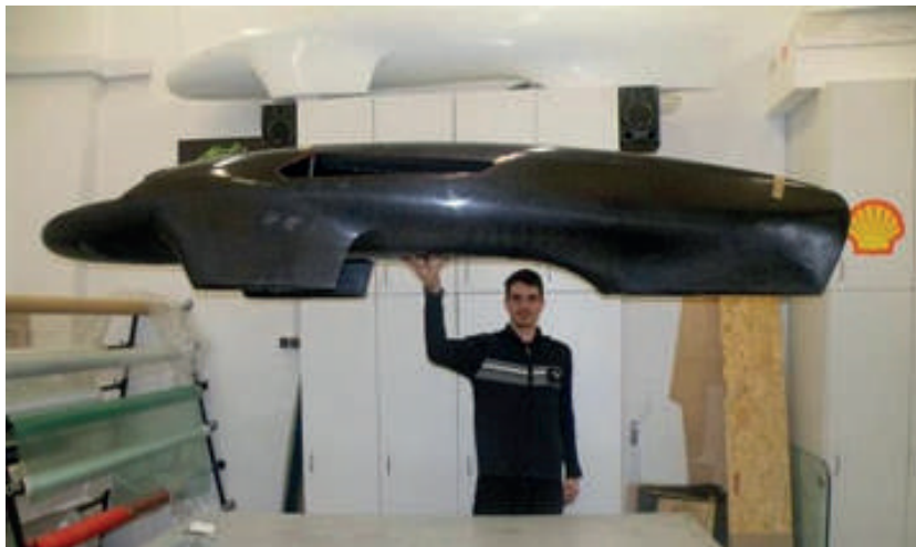
Sujeto levatando el monocasco para demostrar la ligereza del mismo.
