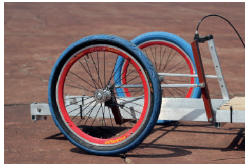
Nueva dirección a base de palancas.
