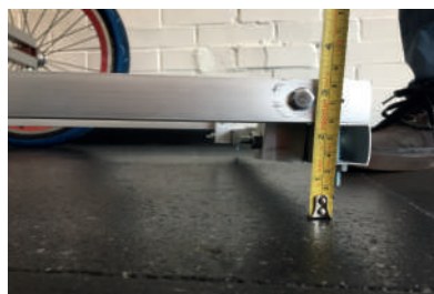
El perfil anterior sufrió deformación con el peso.
