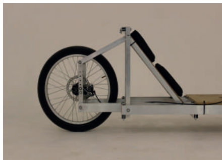
Respaldo del chasis con ángulo de 120°.
