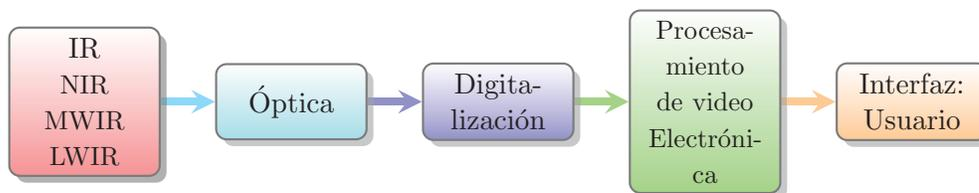
Diagrama 1.1: Diagrama de bloques de una cámara de termografía infrarroja.
