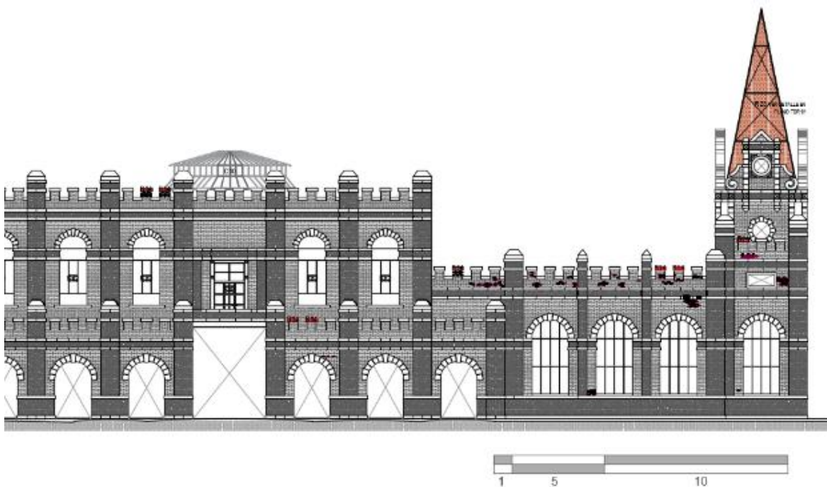
Figura 6.15 y 6.16.- Integraciones en corte X-X' (superior), consolidaciones y reintegraciones en fachada sur oriente (inferior)
