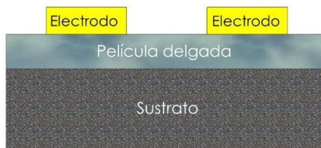
**Figura 3. 16.** Esquema de la geometría de una película delgada para la medición de su impedancia.
