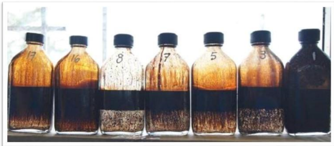
Foto 6.2. Prueba de botella. Observación de cantidad y calidad de agua separada, así como calidad de interfase.
