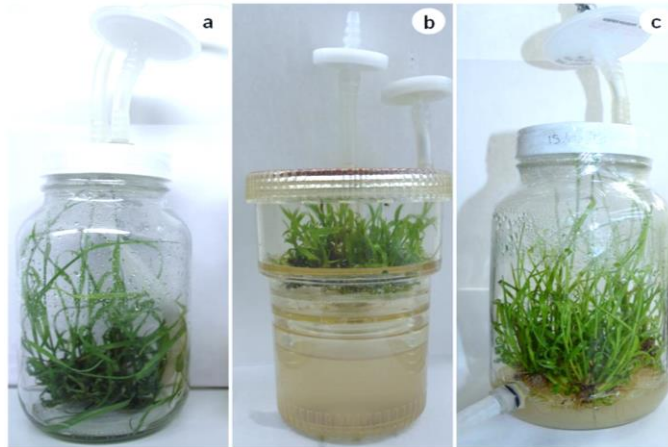
Figura no. 6. Sistemas de Inmersión Temporal. A) Sistema BIT. B) Sistema RITA®. C) Sistema BIG (Bello, et al, 2014).
