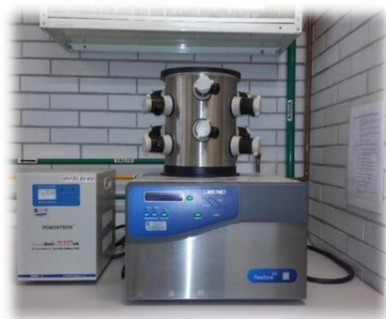
**Figura 25.** Liofilizadora freezezone 4.5
