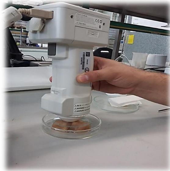
**Figura 30.** Espectrofotómetro de reflectancia, Konika minolta c/m 600
