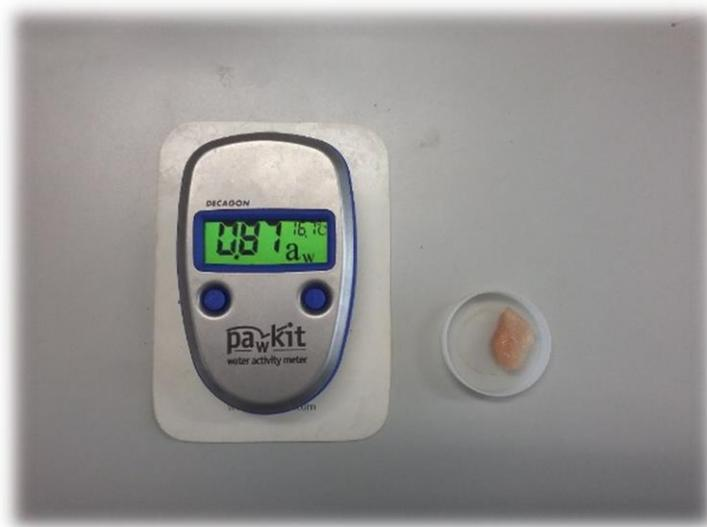
**Figura 28.** Higrómetro de punto de rocío marca Decagon Devices modelo Pawkit
