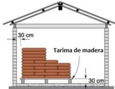
Imagen 2-6. Distancias mínimas para el almacenaje del cemento. 21
