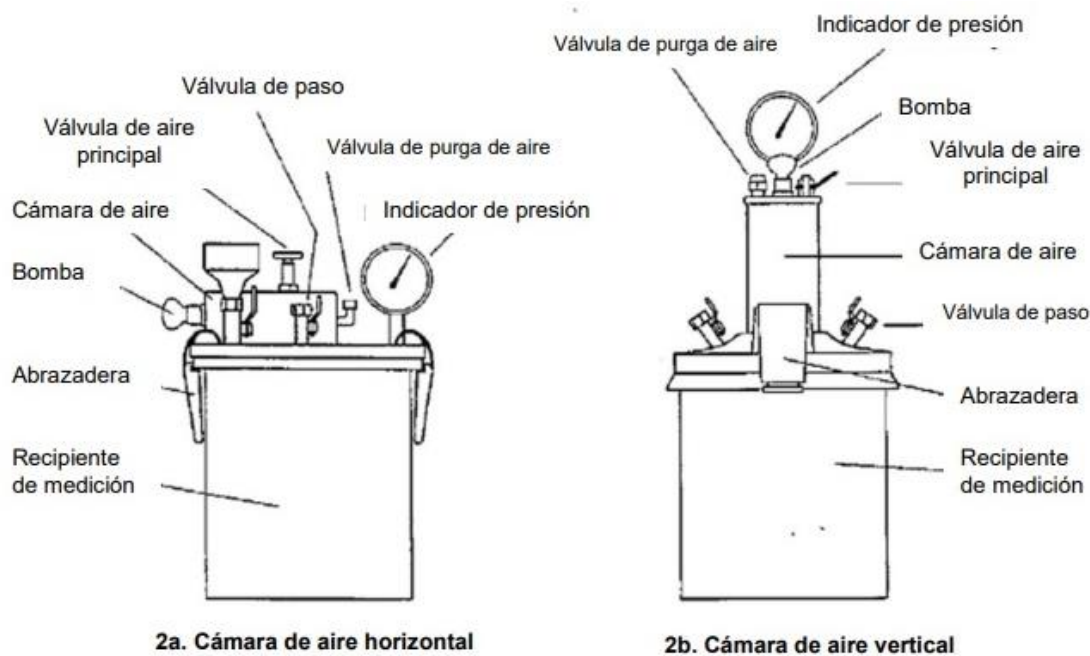
Imagen 11-15. Diagrama esquemático del Medidor tipo B. 124
