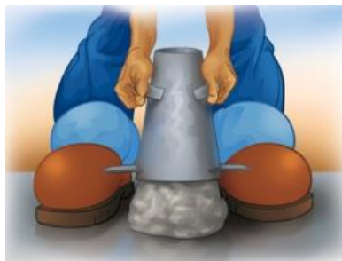
Imagen 11-8. Levantamiento del cono estándar de revenimiento. 115
