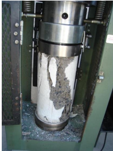
Imagen 11-19. Falla de espécimen sometido a prueba de compresión. 129
