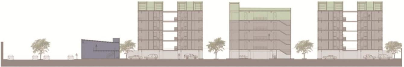
La imagen es un corte de conjunto longitudinal en donde se ejemplifica el acomodo de los elementos del programa pero en alzados, podemos ver el tapanco en el área de los locales; y el estacionamiento en planta baja, con los departamentos encima, y en el último nivel.
