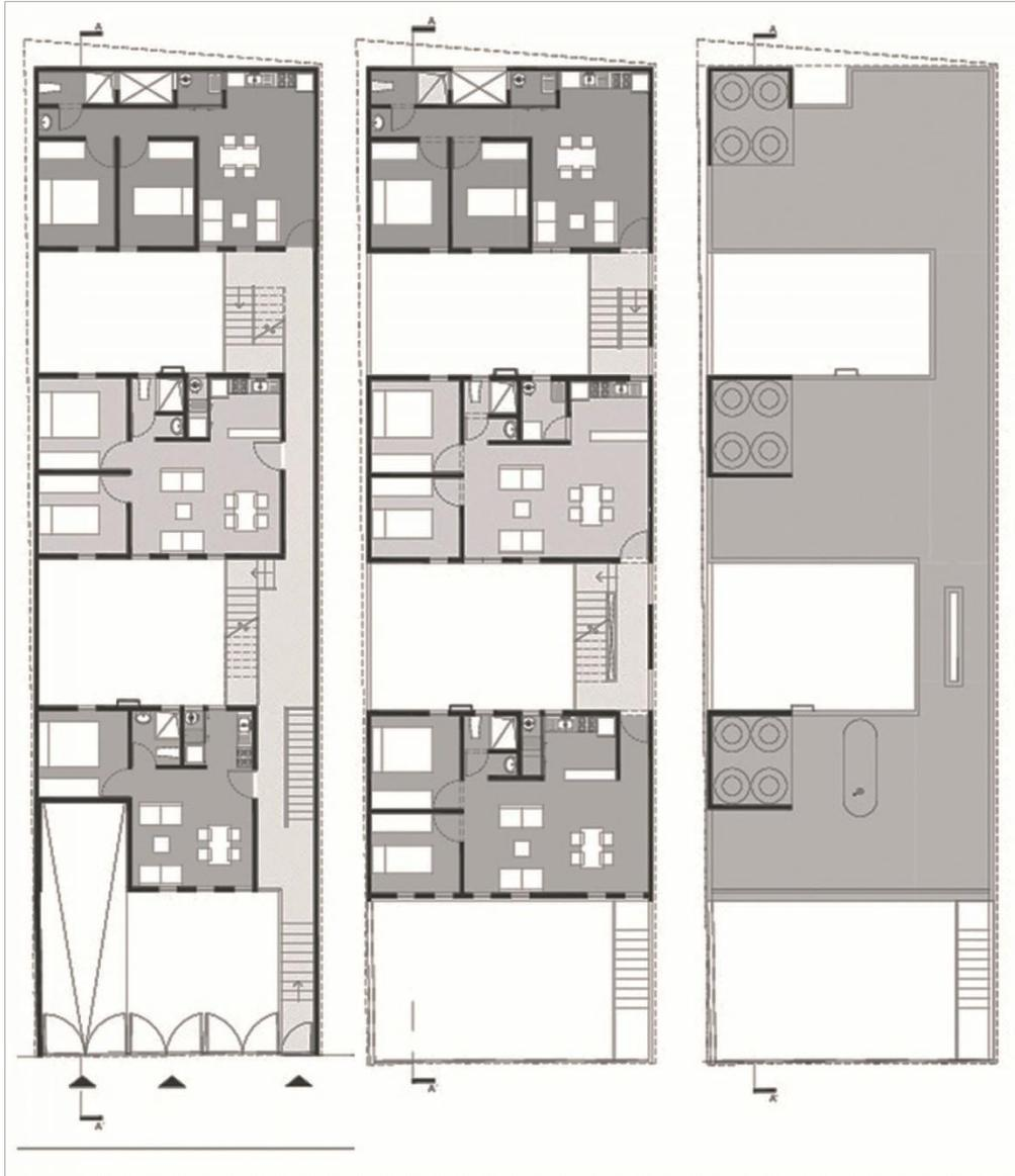
El grafico de a lado muestra de izquierda a derecha, la planta de acceso, después la planta tipo del primer, segundo y tercer nivel, y al final la planta de azotea.
