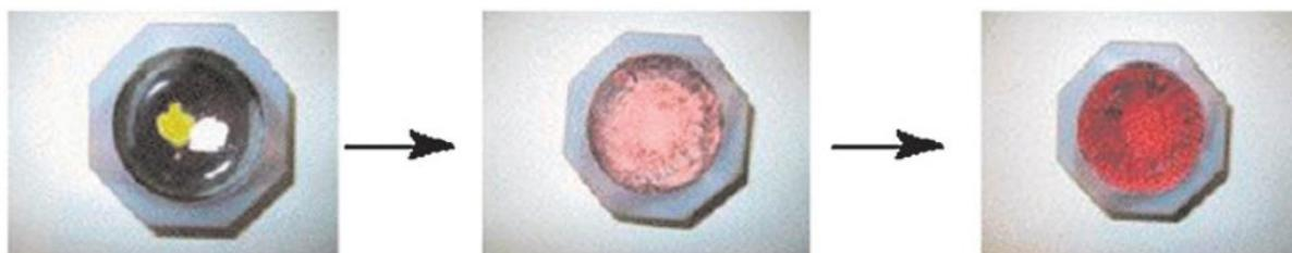
**Figura 9.** Evolución de la síntesis de un cocrystal a través de mecano-síntesis: antes, durante y después de la molienda
