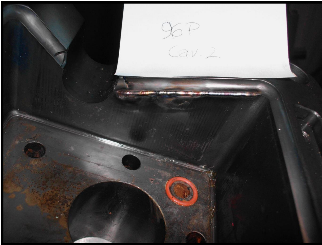
Fig. 75, verificación de o-rings.
