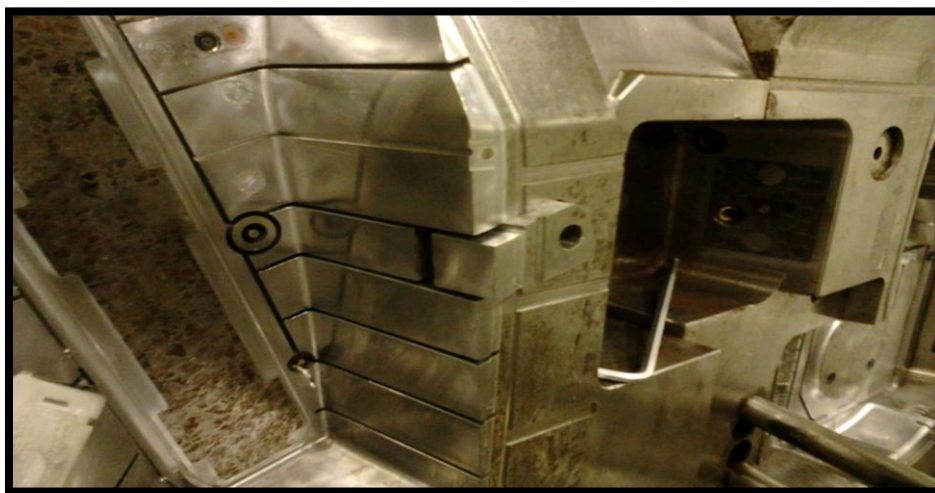
Fig. 66, hundimiento en zona de inserto, por conformado de figura.
