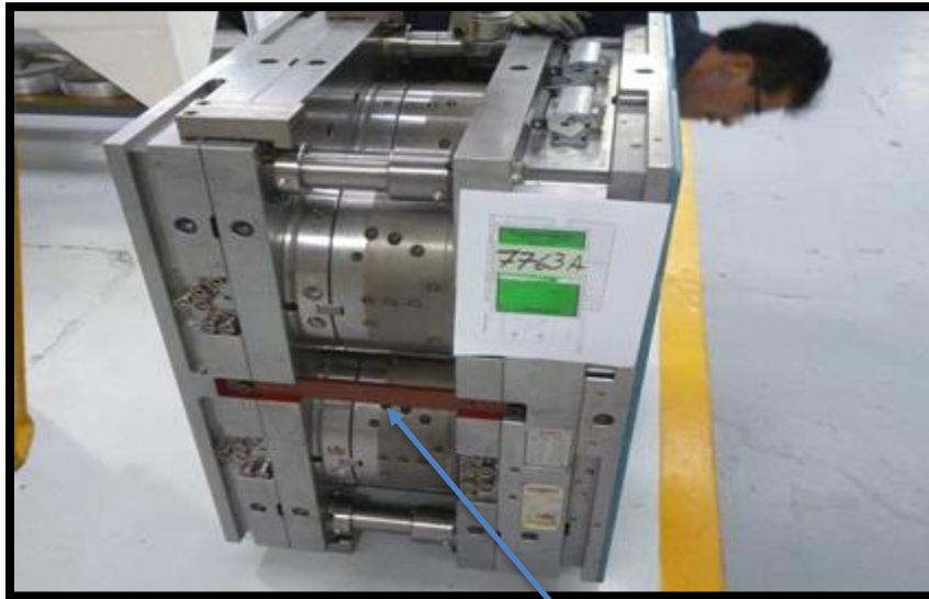
Fig. 93, barras de seguridad, evita la apertura al transportarlo.
