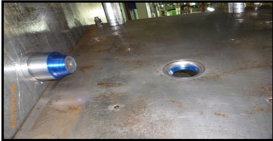
Fig. 19. Sprue primario colada fría.
