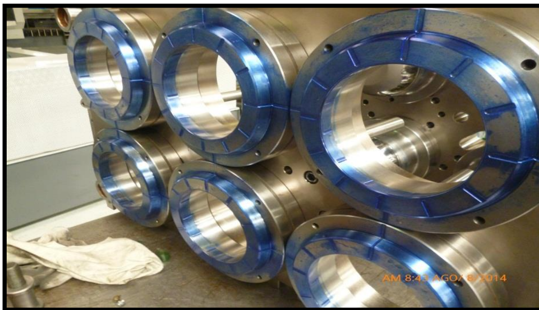
Fig. 31. Sistema de expulsión por anillo.
