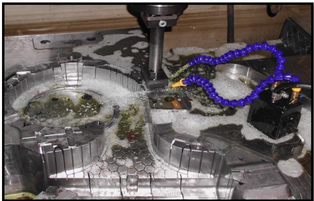
Texturizado por electroeros Fig.69a.
