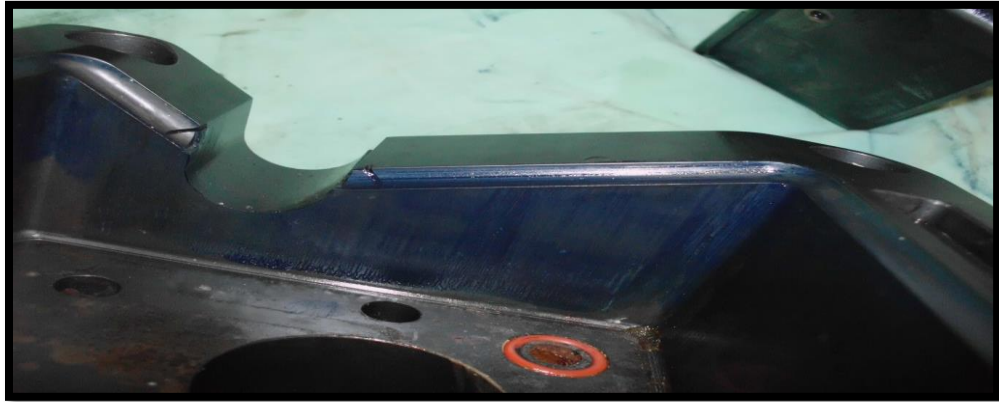
Figura 73, aplicar test de azul de Prusia, verificar cierre.
