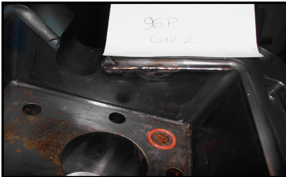
Fig. 80, aplicación de material por láser.
