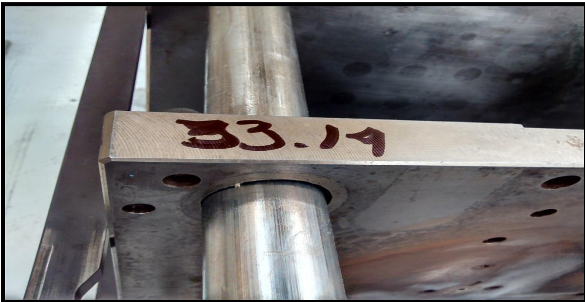
Fig.77. holgura entre buje y perno.
