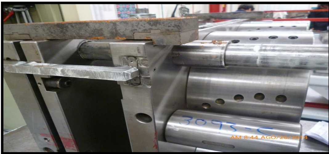
Fig. 26. Tirante limitador de expulsión de colada.
