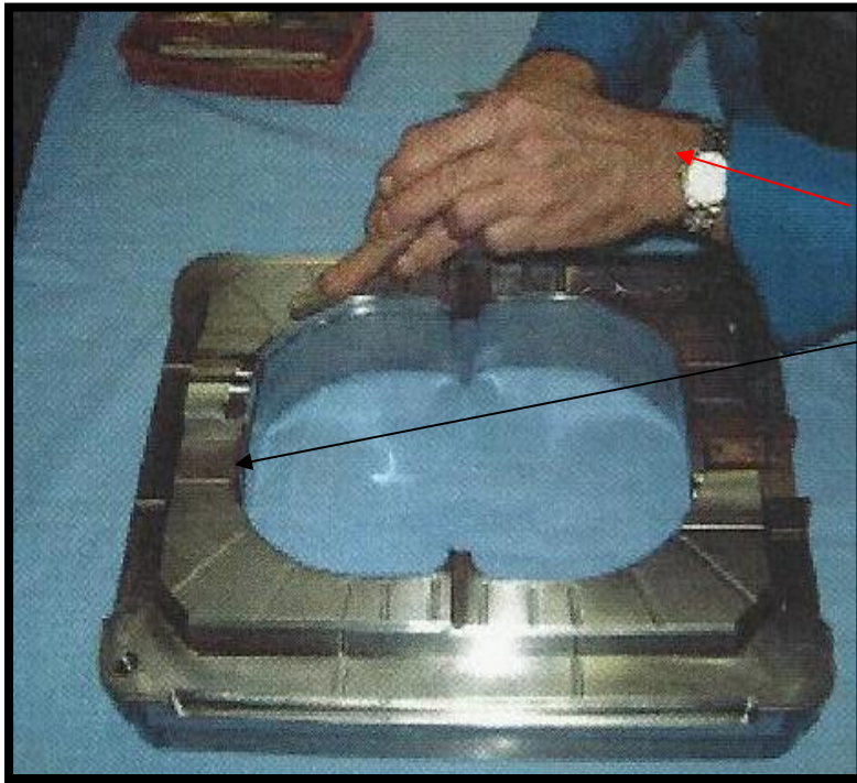
Fig. 103, limpieza de área de sello frontal, NO se debe usar reloj por seguridad.
