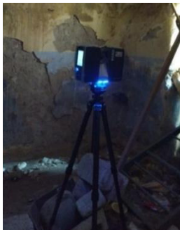
Imagen 14. Escáner láser en sitio.
