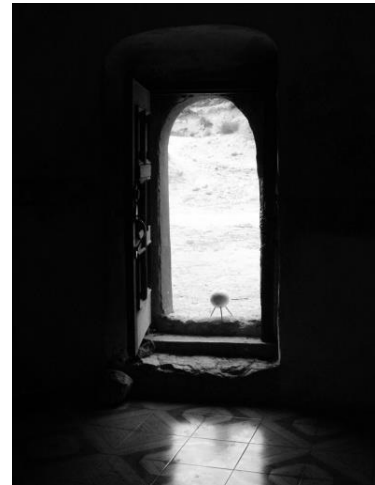
Imagen 19. Referencia esférica en el acceso de la capilla para unir el escaneo interior con el exterior.
