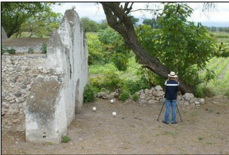
Imagen 17. Emplazamiento del escáner con las referencias esféricas puestas en la fachada y en la parte alta de la portada para escanear la cubierta.
