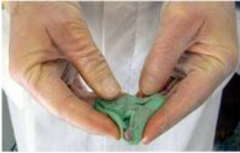
Fig. 28 Mezclado de Masilla y Activador.
