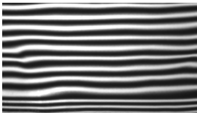
Figura 3.5: Faceta de colector solar plano bajo el análisis de reflexión de luz estructurada (Su et al.)
