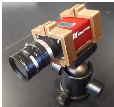
Figura 2.21: Soporte fabricado para la cámara CCD G-125B
