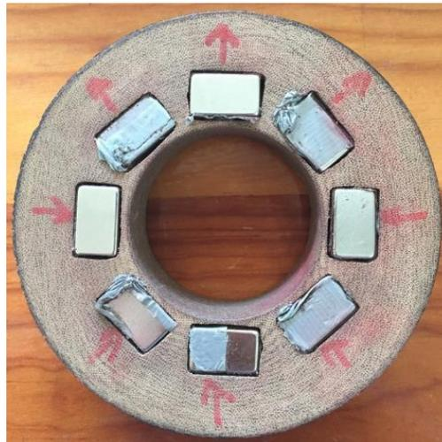
Figura 2.12.- Montaje experimental para el arreglo Halbach circular.
