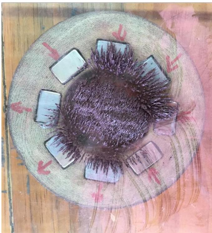
Figura 2.13.- Comprobación práctica del arreglo Halbach construido.
