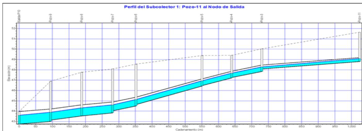
Figura 6-12 Perfil del Subcolector 1 (Pozo-11 a Pozo 10).
