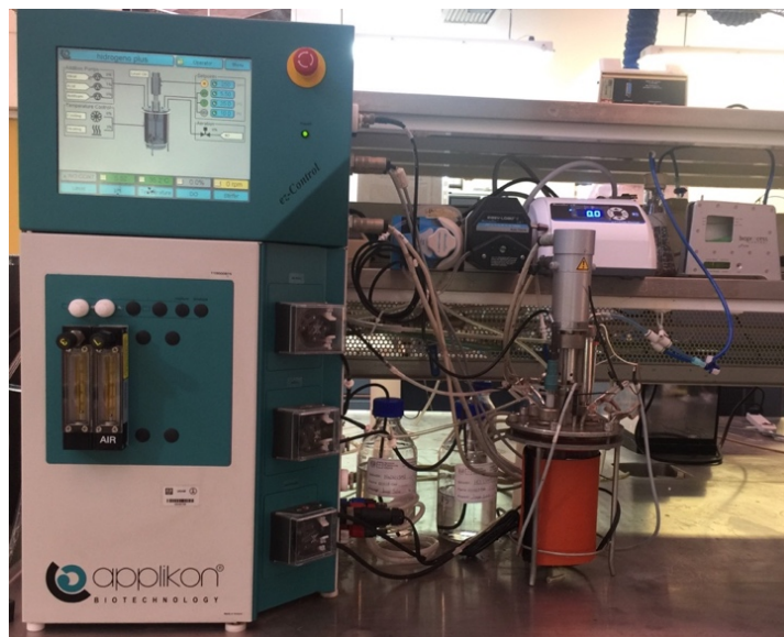
Figura 3.2. Montaje del reactor acidogénico.
