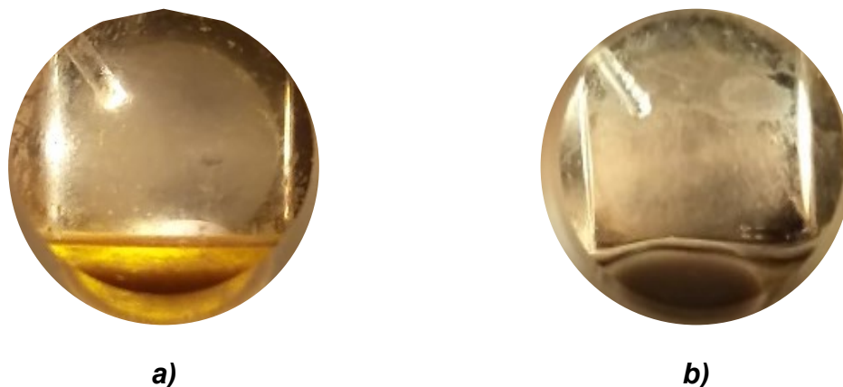
Figura 19. Prueba de visibilidad en la celda de alta presión de L-Leu-OEt (a) y L-Fen-OEt (b) sin disolvente.
