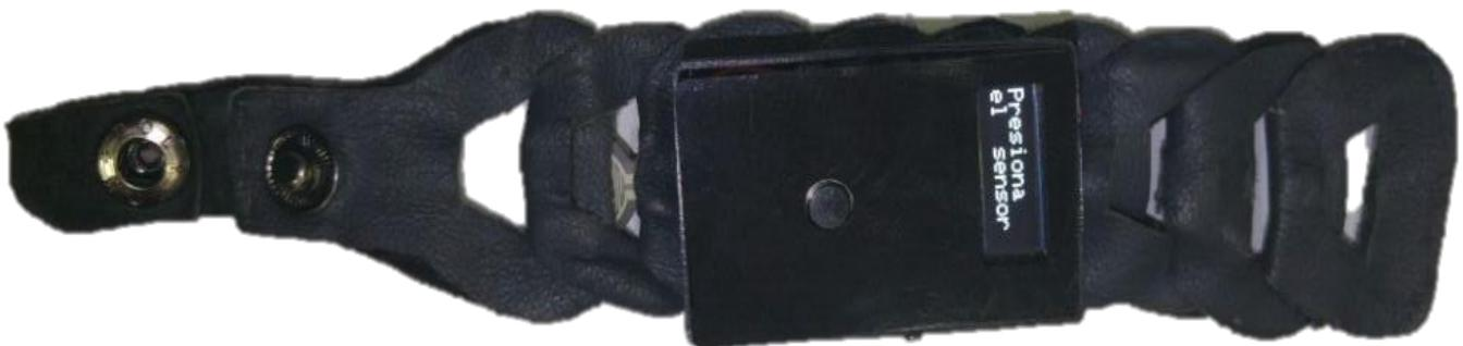
*Figura 1.* Versión final del dispositivo en forma de pulsera. La caja del centro está impresa en 3D y contiene los componentes electrónicos. En la parte frontal se puede observar el botón y la pantalla encendida con la leyenda “Presiona el sensor”.
