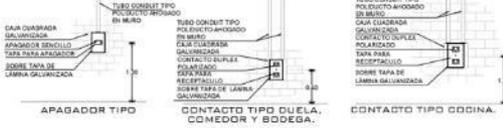
DETALLES CONTACTOS Y APAGADOR
