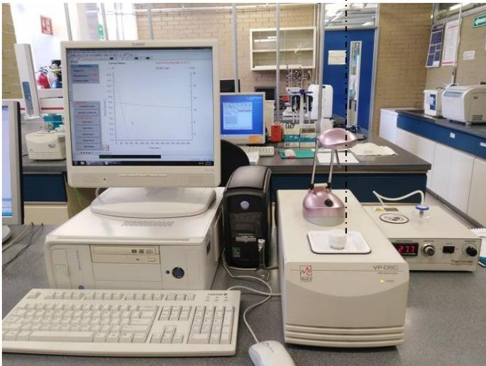
**Figura 4-3. Calorímetro MicroCal VP-DSC**
