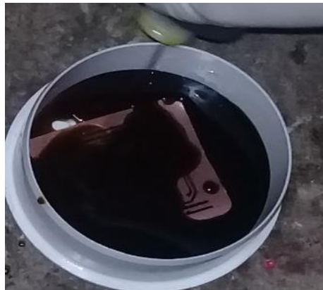
Figura 3.6.1.21. Placa metálica cubierta en cloruro férrico.
