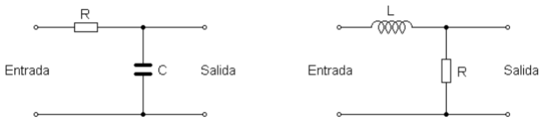
Figura 1.3.1.2. Circuitos pasivos de primer orden de un filtro pasa bajas.
