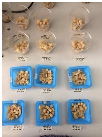
Figura 5. Muestras de papa mínimamente procesada por ultrasonido para la infiltración de diferentes polisacáridos.
