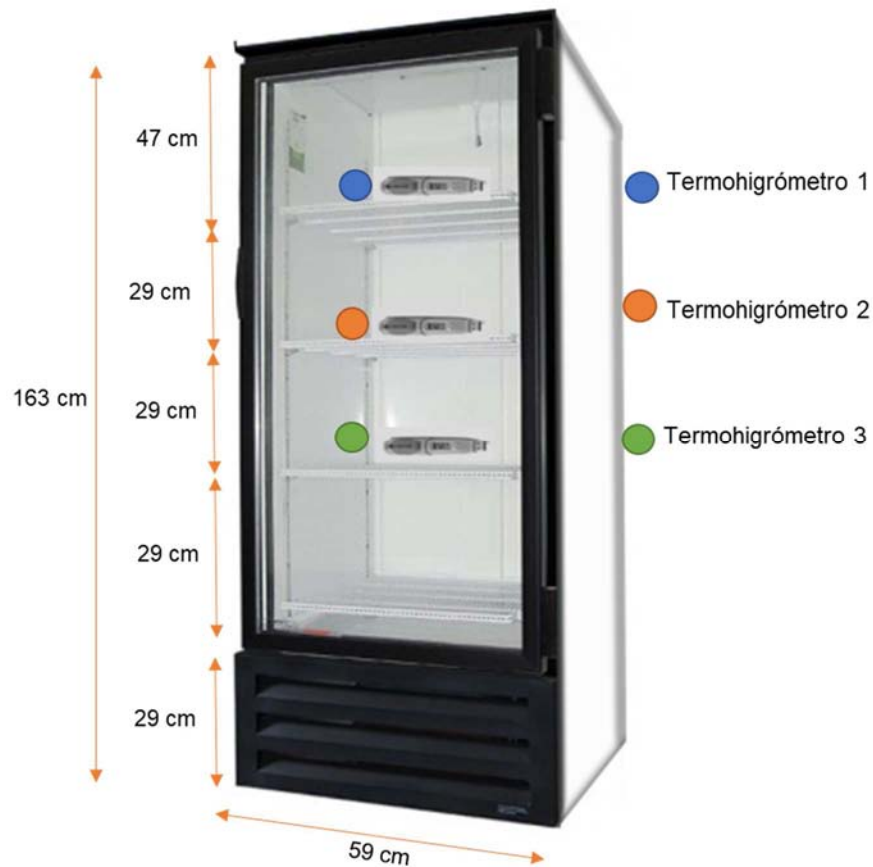
Figura 6. Acondicionamiento de la cámara de refrigeración.
