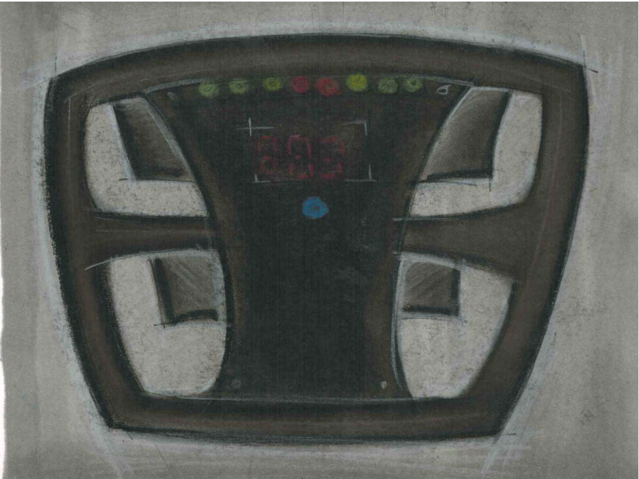
Fig. 70 Boceto con tapa independiente de las sujeciones de la "Quick Release"
