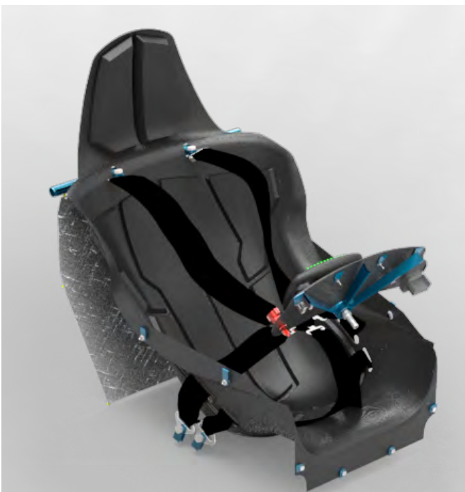
Fig 23. Asiento, cinturones de seguridad y firewall.
