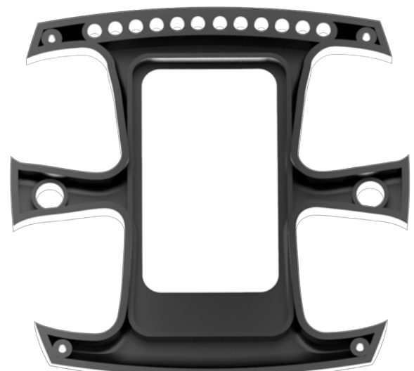
Fig. 76 Vista superior e inferior de la tapa del volante con el acrílico montado
