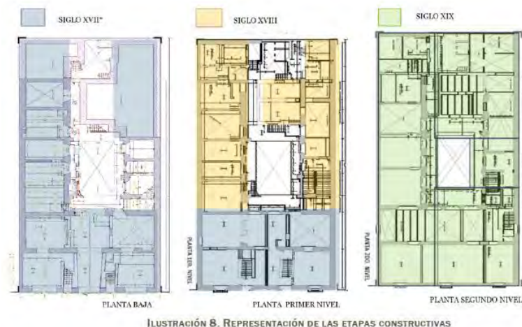
Imagen No. 7.- Representación de las etapas constructivas de Jesús María No. 42,44 y 46 (Santiago, 2016).
