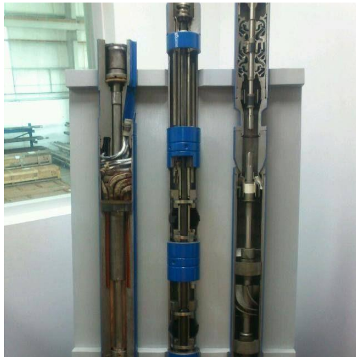
Figura 1.13 Componentes de Bombeo Electrocentrífugo
