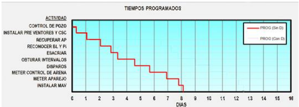
Figura 3.17 Tiempos de Ejecución de RMA del Pozo "A"
