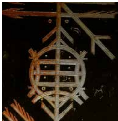
39, 40, 41 Detalles de atacado luego de 4 horas en ácido nítrico industrial. Se observa además la oxidación como proceso natural. Fotos: Pamela Vallejo
