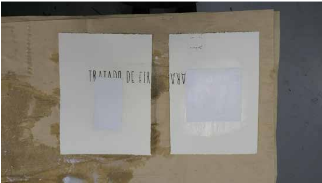
107 Aplicación de sellador utilizando papel de fibra de bambú de 300g. A partir de estas pruebas no se volvió a deslizar la tarjeta para retirar excesos, simplemente se cuidó que no quedaran burbujas de aire. Foto: Pamela Vallejo
