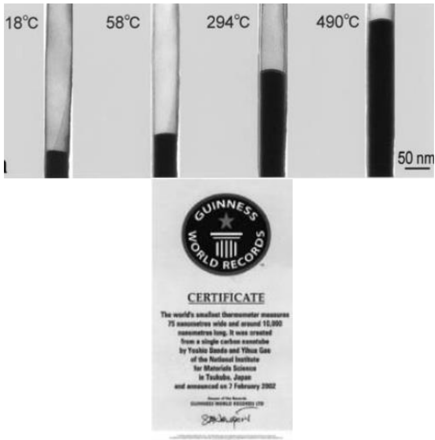
Figura 2. Imágenes de TEM, se muestra un nanotubo con Ga líquido a distintas temperaturas. Certificado de Record Guinness para el termómetro más pequeño. Figuras tomadas de [56].
