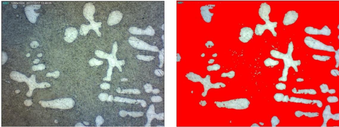
Figura 25. Imagen de Aleación Al-Si hipoeutéctica 12%Si. Del lado izquierdo la imagen original del lado derecho la imagen con la fase primaria resaltada en rojo.
