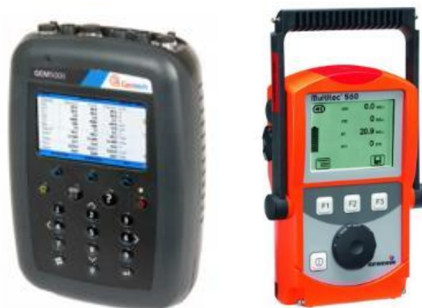
Figura18. A la izquierda medidor GEM5000, a la derecha analizador portátil de biogás Multitec 560.
