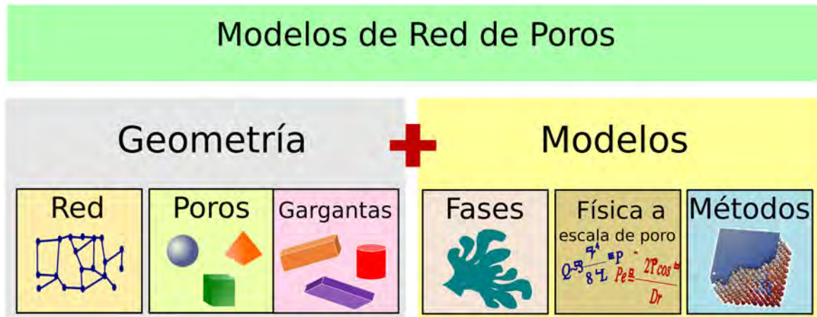
Figura 3.8: Elementos de una red de poros. En general, los elementos clave de los modelos de red de poros son la estructura del medio y el conjunto de ecuaciones que describen los fenómenos a escala de poro. En este trabajo, estos elementos principales se descomponen en: (i) red, (ii) geometría, (iii) fases, (iv) física a escala de poro, y (v) métodos. Los nuevos elementos permiten obtener una mejor comprensión general del fenómeno.
