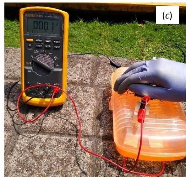
Figura 1.1 En la imagen (a) se muestra una celda solar de union p-n de ZnO/Cu 2 O fabricada a partir de dos pastas de los compuestos Cu 2 O y ZnO untadas sobre vidrios con recubrimientos conductores transparente de ITO. En (b) se muestra la celda expuesta al Sol generando un pequeño voltaje. En (c) se observa la eliminación del voltaje al teparle la luz a la celda.
