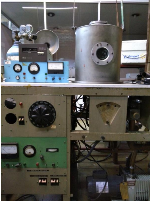
Figura 3.1. Sistema de vacío usado para la evaporación térmica ubicado en el acelerador de Van De Graaff 0.7 Mev, del IF-UNAM.
