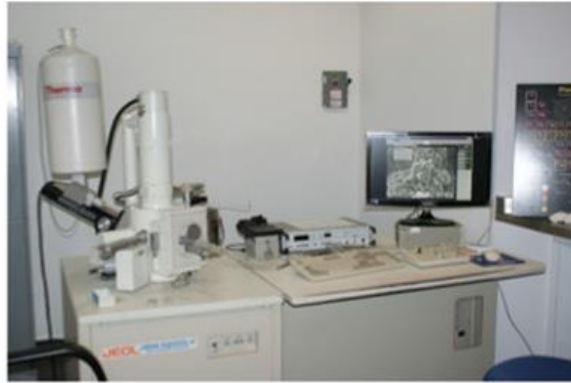
Figura 3.6. Fotografía del Microscopio Electrónico de Barrido SEM 5600LV del Laboratorio Central de Microscopía del Instituto de Física de la UNAM.
