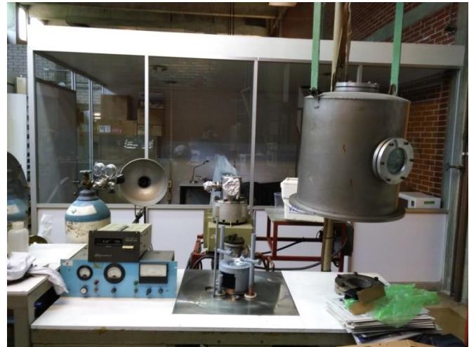
Figura 3.1. Sistema de vacío usado para la evaporación térmica ubicado en el acelerador de Van De Graaff 0.7 Mev, del IF-UNAM.
