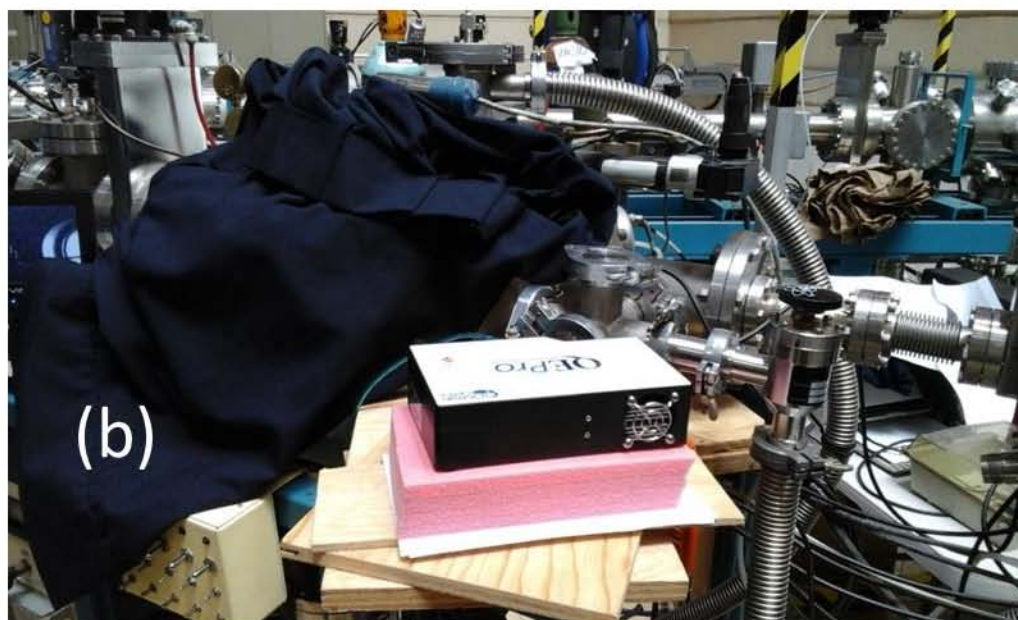
Figura 3.5. En (a) se muestra el interior de la cámara de vacío en donde se observa la fibra óptica apuntando hacia el portamuestras. En (b) se muestra el exterior de la cámara y el espectrofotómetro analizador de la luz emitida por la muestra.
