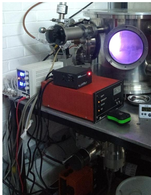
Figura 3.2. Sistema de vacío para el método de sputtering, dentro de la cámara de vacío se realiza una descarga de gas auto sostenida de Argón sobre las muestras de vidrio sódico cálcico con recubrimiento de ITO.
