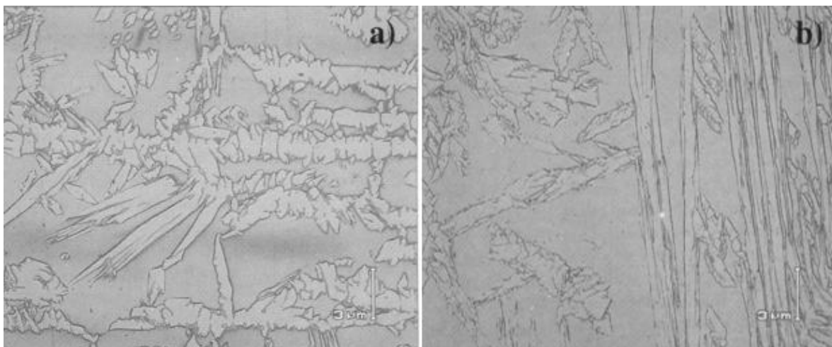
Figura 30. a) Detalle de la zona afectada por el calor 500X, b) Detalle del metal de aporte 500X
