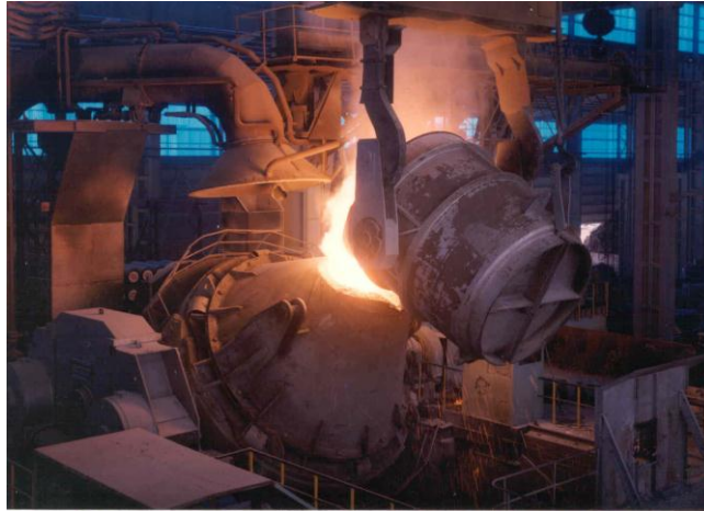
Figura 10. Operación de descarga de la cuchara de trasvase al convertidor AOD
