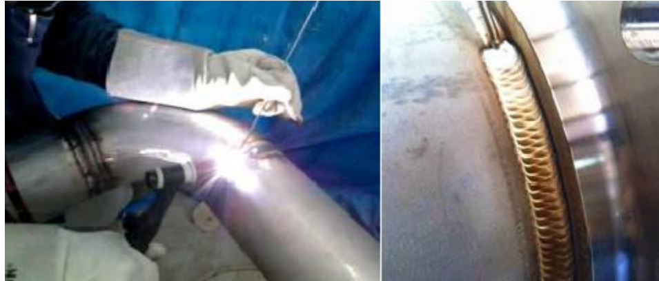
Figura 26. Imágenes de un equipo fabricado con el proceso de GTAW, en las cuales se puede observar una buena calidad en la soldadura.
