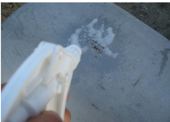
Figura 17. Paso 1: Aplique E-NOX Clean y dejarlo reposar durante 3 minutos
