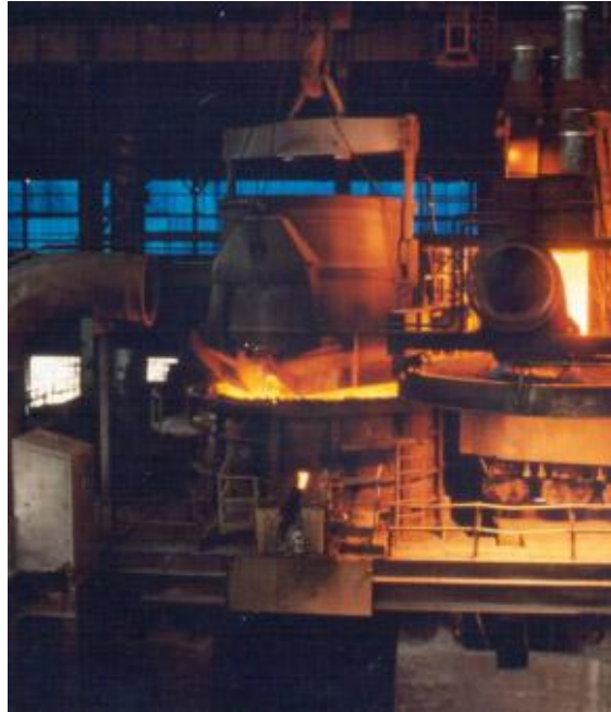
Figura 9. Cesta de carga volcando en Horno Eléctrico
