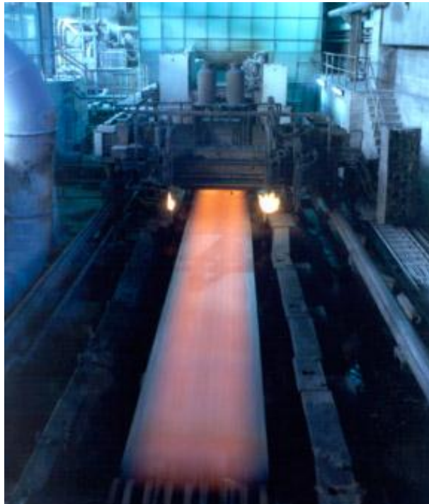
Figura 11. Colada continua de desbastes
