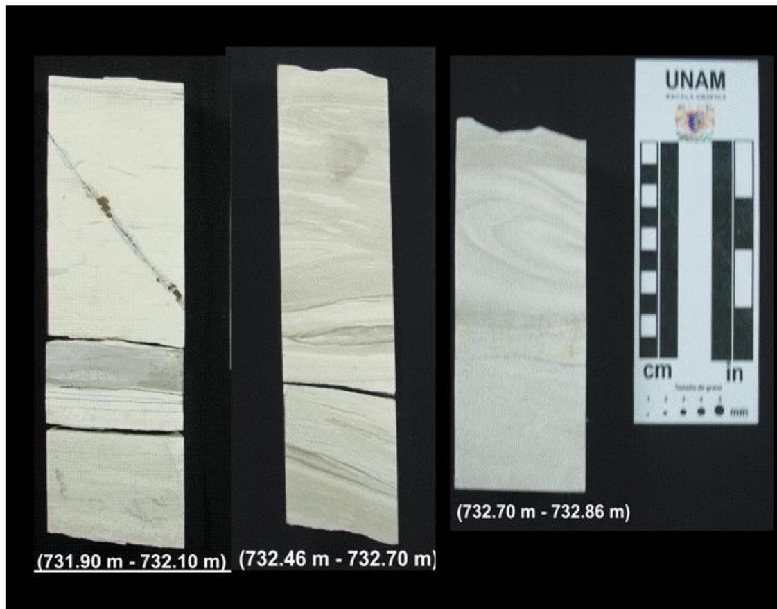
Figura 19. De izquierda a derecha (profundidad de 731 m a 732 m), se observa el fracturamiento relleno por pirita, con finas laminaciones horizontales. En la parte media se observan laminaciones inclinadas de color pardo; en la derecha (732.46 m a los 732.86 m), se observan plegamientos de deformación suave, en pliegue intraformacional producto por la plasticidad de los materiales.
