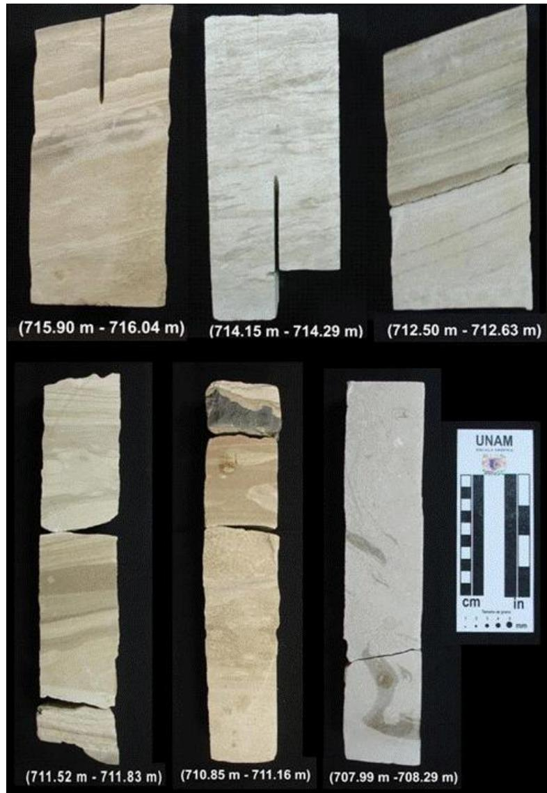
Figura 22. Laminaciones de espesores finos con variaciones de carbonato entre los 714 m y 712 m. En el núcleo con profundidad de 707.99 a 708.29 m se observan zonas de flujo provocadas por la silicificación.
