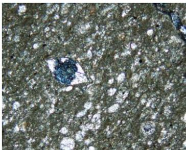
Lámina 34fb. Muestra Pyax-154. Packstone de foraminíferos planctónicos con alteración diagenética por reemplazamiento de sílice en sus cámaras. LTNC, 5X.
