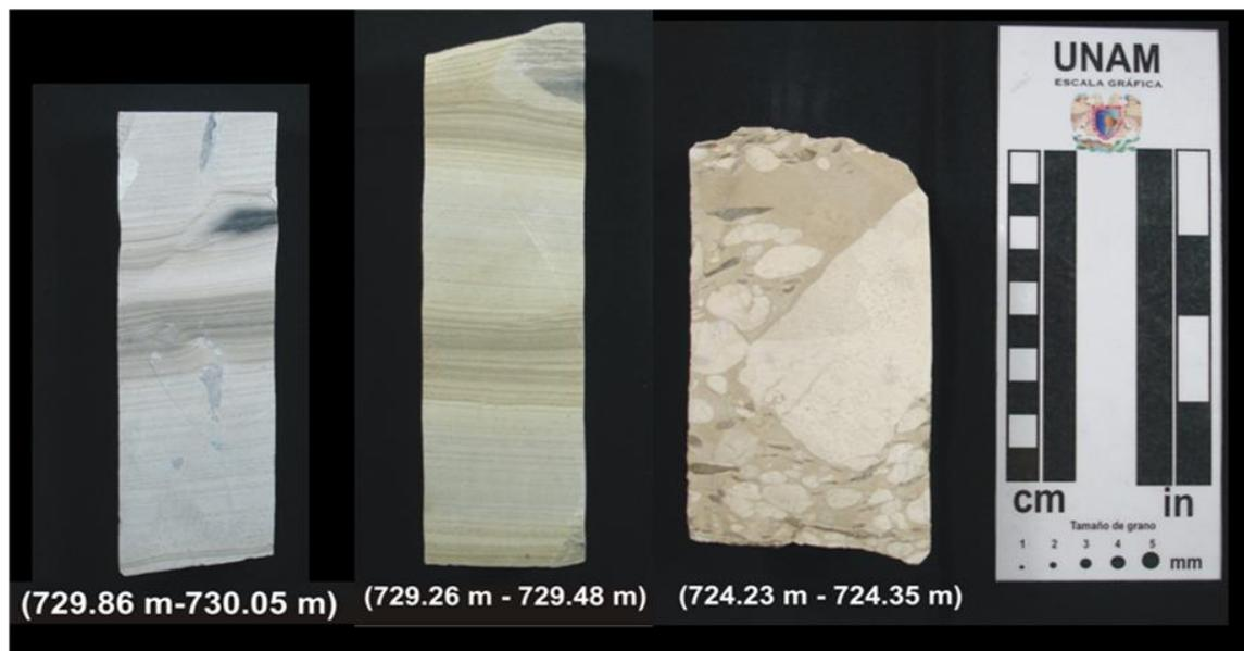
Figura 20. Los fragmentos de núcleo muestran finas laminaciones de color pardo. El núcleo de la izquierda (729.86 m a 730.05 m), presenta un microfallamiento. En la parte superior del núcleo central (a partir de los 729.26 m.), se muestra un pseudoclasto, donde se da un proceso de silicificación sobre la textura laminar (flujos silicificados). El fragmento de la derecha (724.23 m a 724.35 m), muestra el intervalo de brecha.
