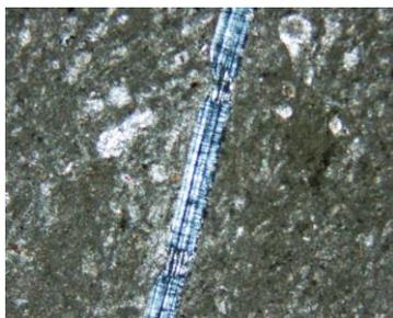
Lámina 41d. Pyax-231. Wackestone con fragmentos de gasterópodos, espículas de equinodermos sustituidos por pedernal. LTNP, 20X.
