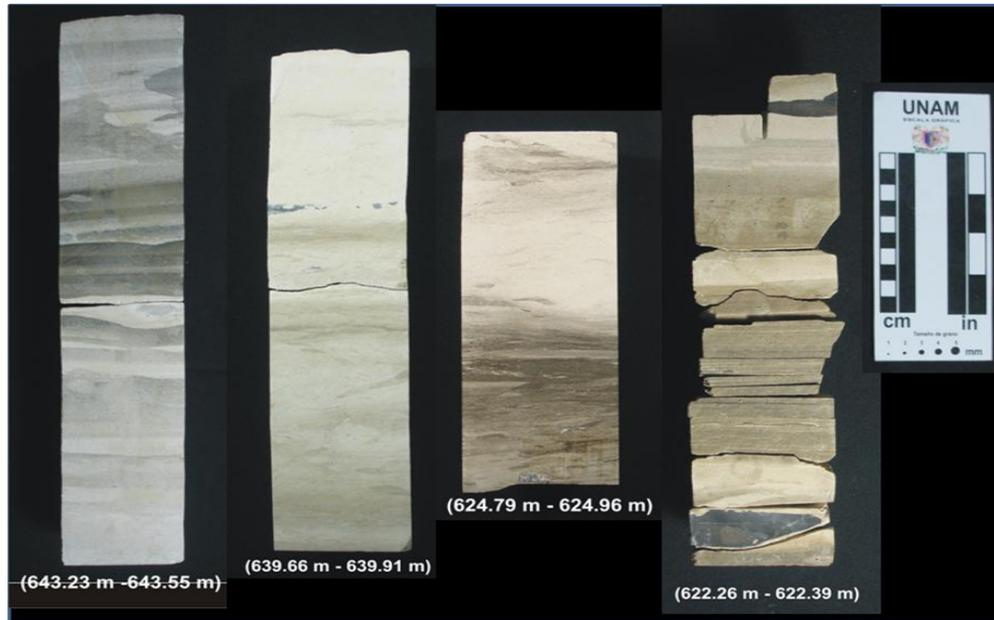
Figura 29. Se presentan diferentes testigos de núcleo donde se muestra la ritmicidad de las láminas de material arcilloso, intercalados con wackestone y algunos lentes de pedernal.
