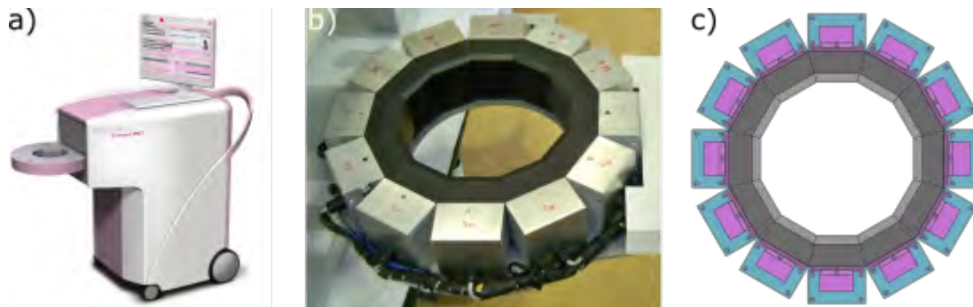
Figura 2.4 – a) Escáner PET MAMMI. b) Fotografía del anillo de detectores. c) Esquema de la geometría en anillo de los detectores [Moliner et al. 2010].
