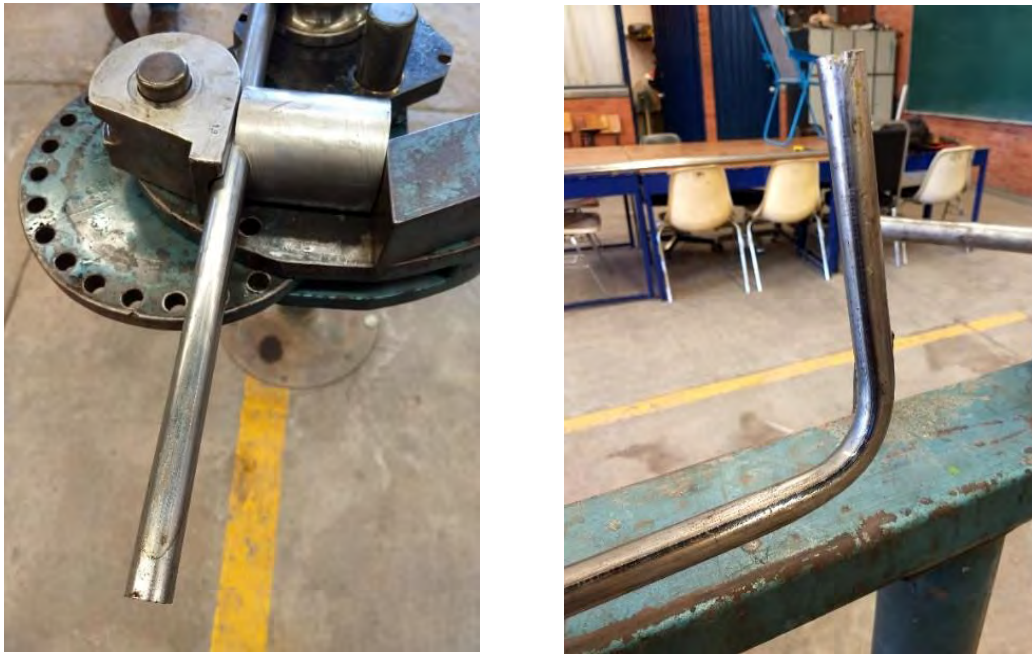
Figura 5.3 Prueba de dobléz a 90° en tubería industrial de 3/4" cal. 16 con dados 19 mm.
