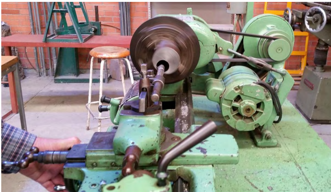
Figura 4.15 Desbaste de barreno con barra de centros en torno sujetando la pieza en un Chuck de 4 mordazas.
