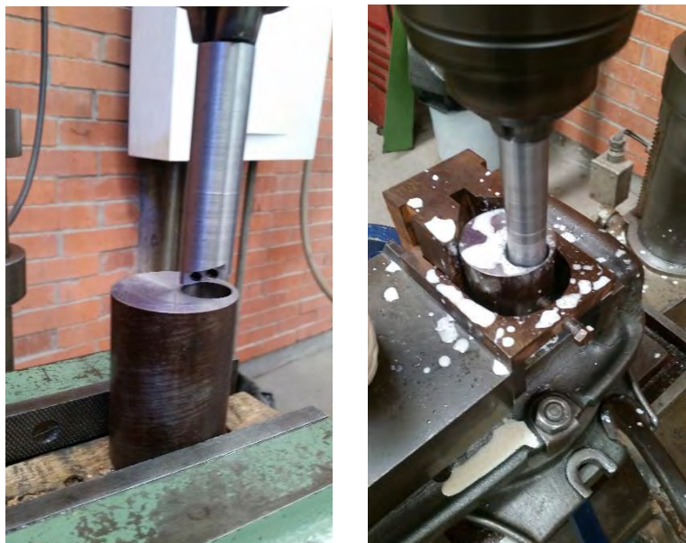
Figura 4.13 Barrenación por medio de dispositivo pecho paloma en taladro vertical.
