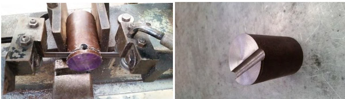
Figura 4.41 Corte y refrentado frontal de opresor para dados de 13 mm.
