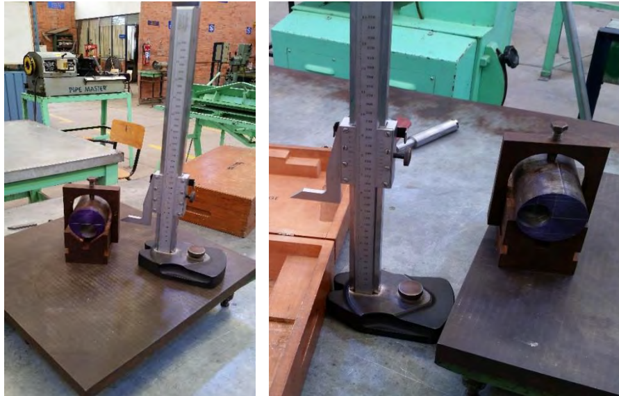
Figura 4.16 Trazo de centros y contornos con calibrador de alturas.
