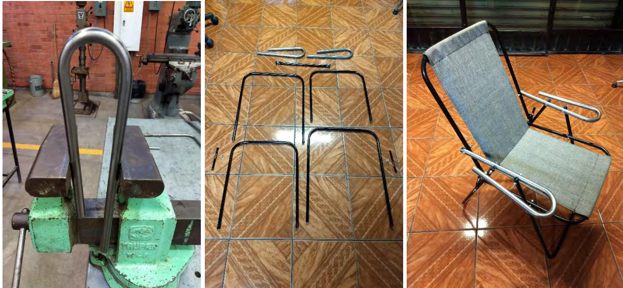
Figura 5.11 Preparación de piezas para armar la silla y el resultado final.
