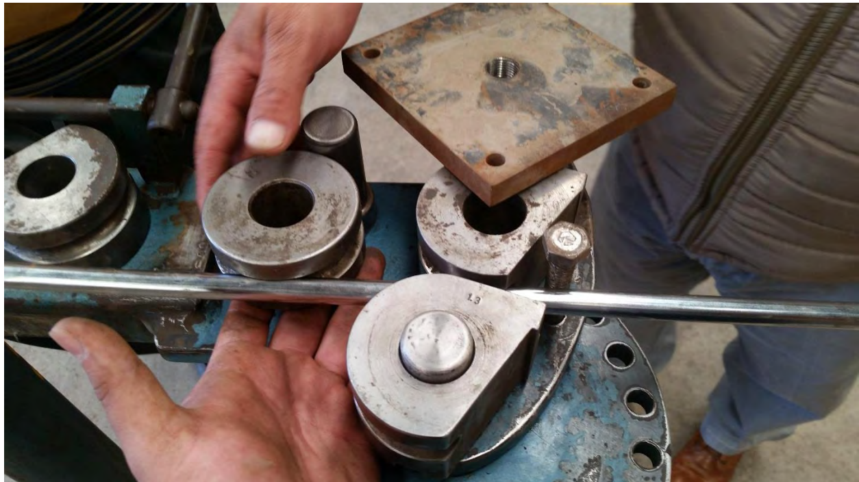
Figura 4.29 Presentación de dado y polea 13 mm para prueba y error, analizando la posibilidad de desplazar la polea mediante a un punto más conveniente.
