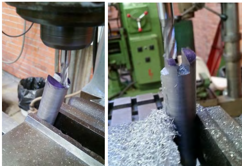
Figura 4.11 Nos muestra el maquinado en la fresadora de las ranuras para una mayor versatilidad.
