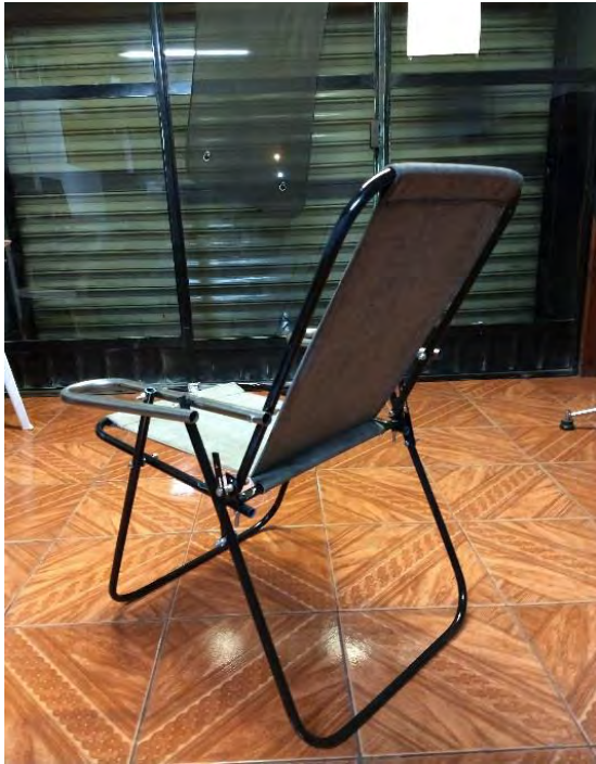
Figura 5.7 Silla plegable fabricada con maquina dobladora de tubo en LIME II Manufactura.
