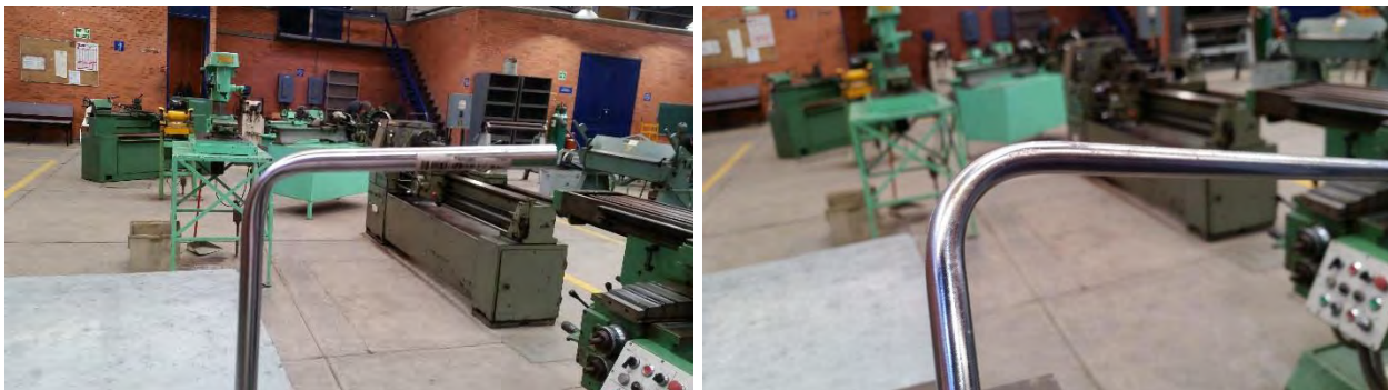
Figura 4.52 Comparativa de resultados en doblez de tubo de 1/2" con dados de 13 mm.
