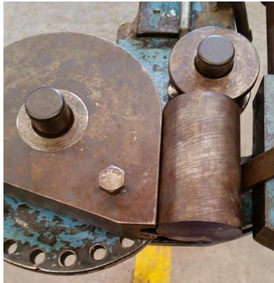
Figura 4.4 Barra de acero para fabricación de opresor para dados de 29 mm.
