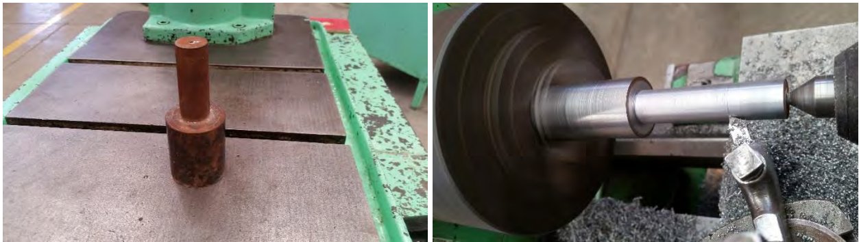
Figura 4.36 Cilindrado de dispositivo porta polea.
