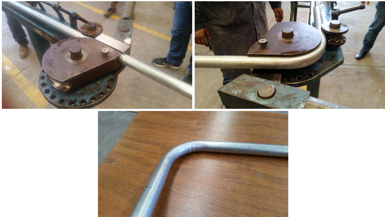
Figura 4.22 Pruebas de doblez en tubería con dados 29 mm.
