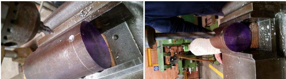
Figura 4.40 Barrenación escalonada de opresor para dados de 13 mm.
