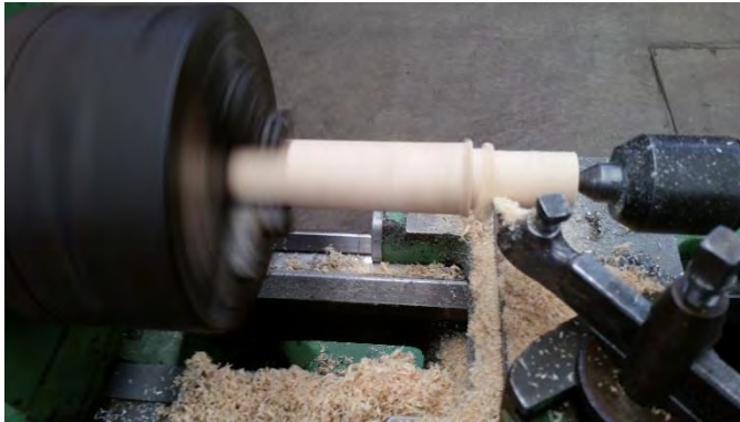
Figura 4.14 Fabricación de dispositivo de madera para descentrar pieza en el torno con Chuck de cuatro mordazas.
