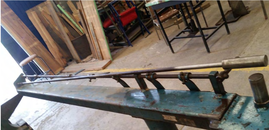
Figura 4.27 Montaje de mordaza tipo inserto en la dobladora de tubos.
