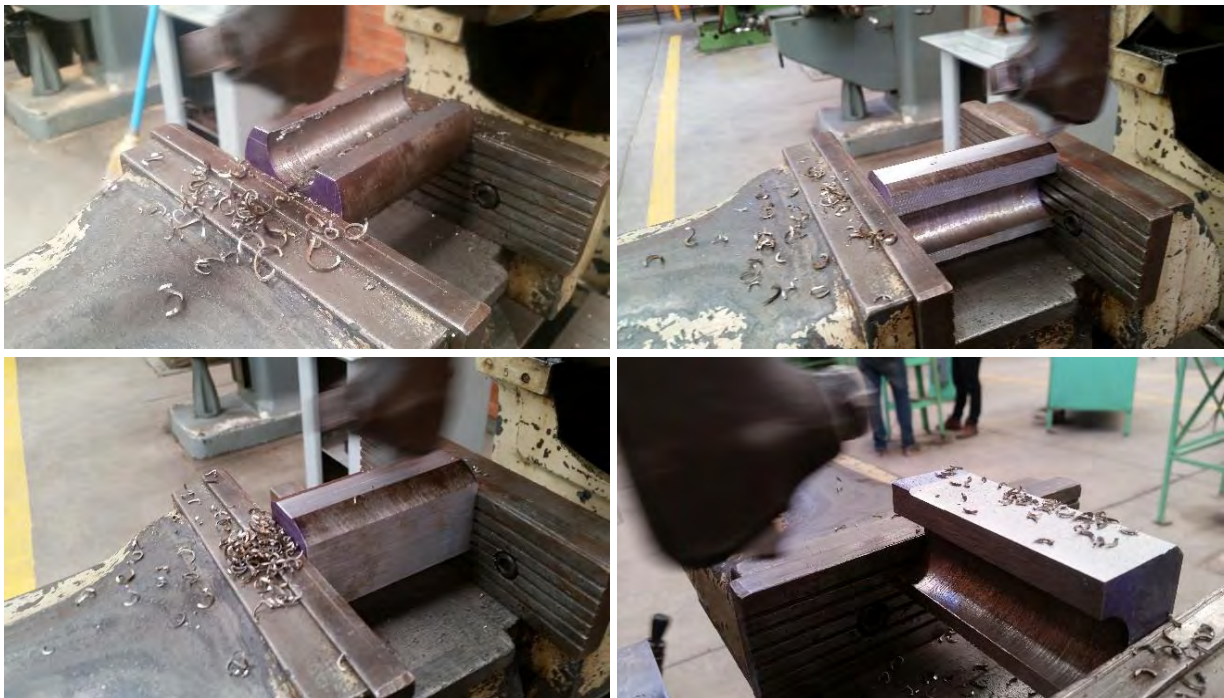
Figura 4.17 Maquinado de opresor para dados de 29mm en cepillo.
