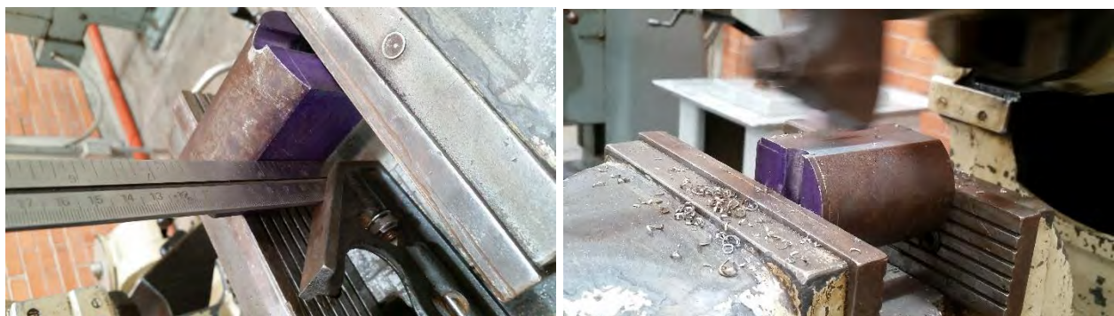
Figura 4.47 Alineación perpendicular y desbaste de una cara de opresor para dados 13 mm en el cepillo.
