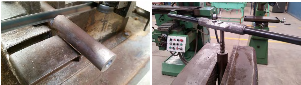
Figura 4.26 Corte y roscado de mordaza para tubo de 29 mm diámetro exterior.
