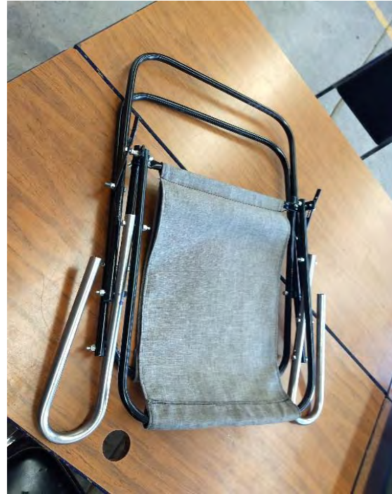
Figura 5.7 Silla plegable fabricada con maquina dobladora de tubo en LIME II Manufactura.
