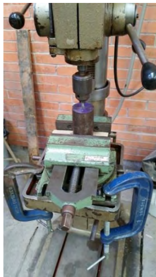
Figura 4.7 Fijación de la pieza a trabajar en una prensa y esta a su vez sujeta con prensas de carpintero en un taladro vertical para realizar la secuencia escalonada de las barrenaciones
