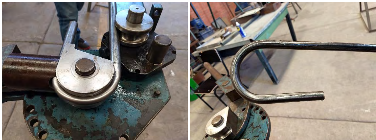
Figura 5.4 Prueba de curvado a 180° en tubería industrial de 3/4" cal. 16.
