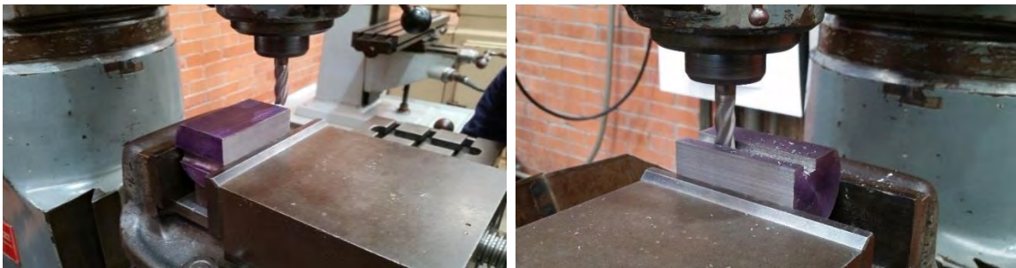
Figura 4.50 Maquinado de ranura inferior para opresor de dados 13 mm.
