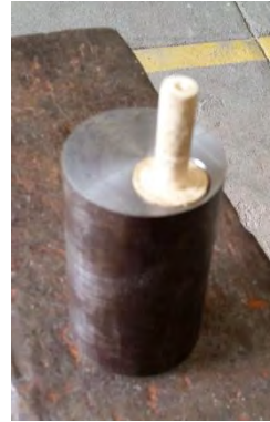
Figura 4.14 Fabricación de dispositivo de madera para descentrar pieza en el torno con Chuck de cuatro mordazas.
