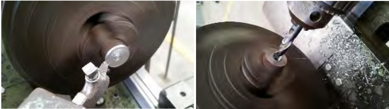
Figura 4.25 Se muestra el refrentado y la barrenación para hacer cuerda con machuelo \frac{1}{2} " 13 hilos.
