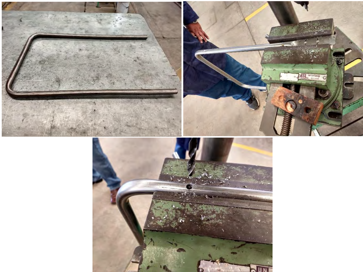
Figura 5.13 Doble y perforaciones para refacción de podadora.
