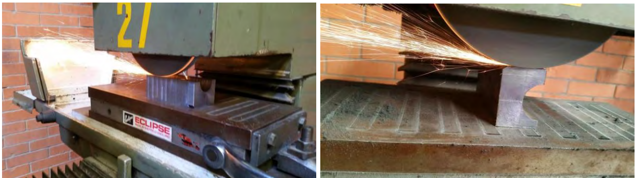
Figura 4.19 Se muestra el rectificado de opresor para dados de 29 mm.
