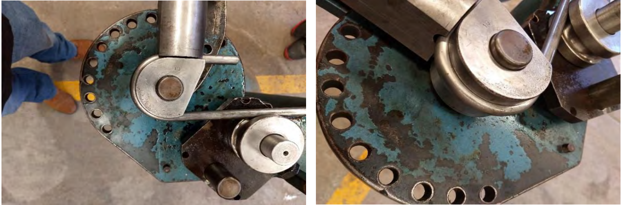
Figura 5.2 Pruebas de curvado a 180° en tubería industrial de 1/2" cal. 18 con dados 13 mm en dobladora.
