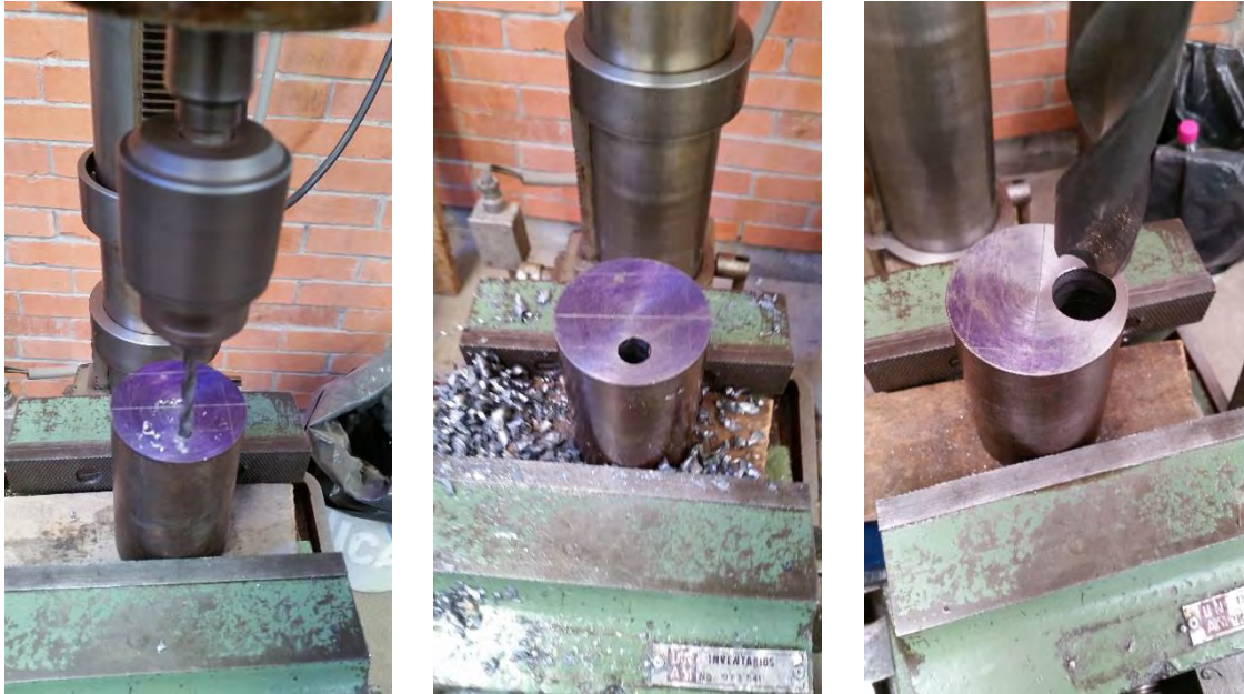
Figura 4.8 Se muestra la secuencia de barrenación con diferentes tamaños de brocas.
