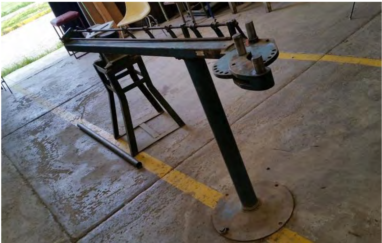
Figura 4.1 Dobladora de tubo inhabilitada en LIME II Manufactura.
