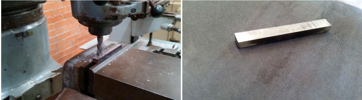
Figura 4.51 Maquinado de barra donde se montarán el dado y el opresor de 13 mm.
