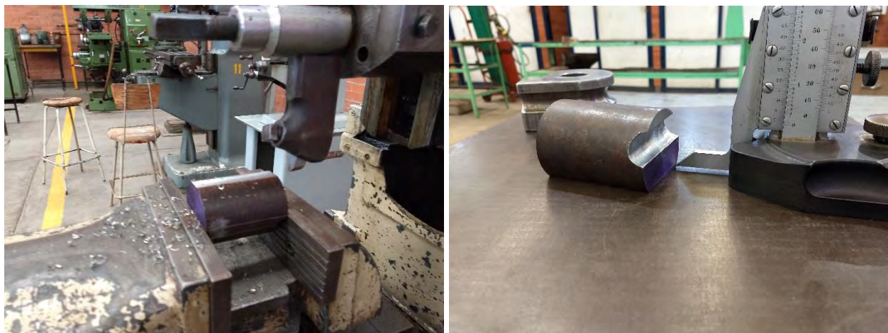
Figura 4.57 Desbaste de cara inferior del opresor para dados de 19 mm y corroborando con el calibrador de alturas
