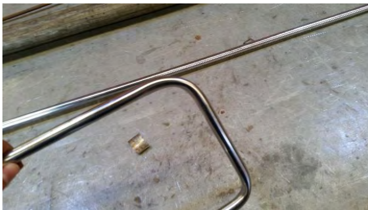
Figura 4.48 Resultado de la prueba mostrando aplastamiento en el lomo y la garganta de la curva.
