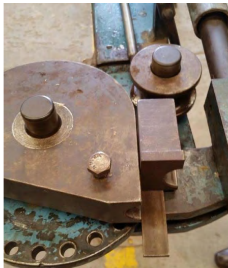
Figura 4.3 Presentación de dado y polea 29 mm. en dobladora.
