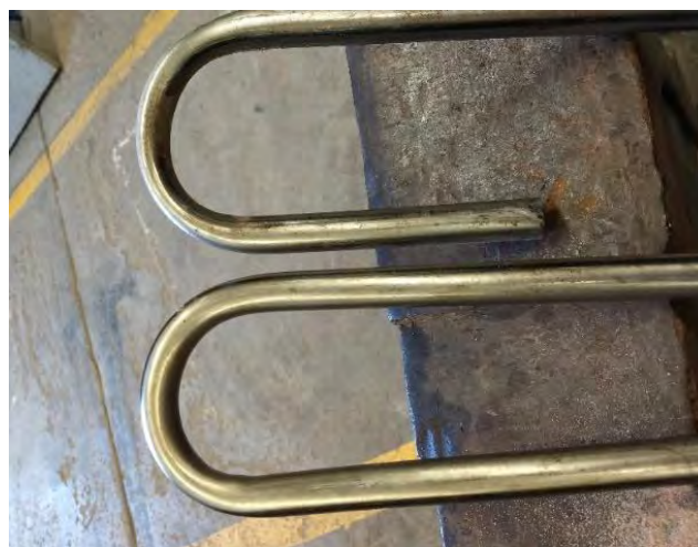
Figura 5.6 Comparación de doblado a 180° en tubería industrial de 3/4" cal. 16. A la izquierda uno relleno con arena y a la derecha uno sin relleno.
