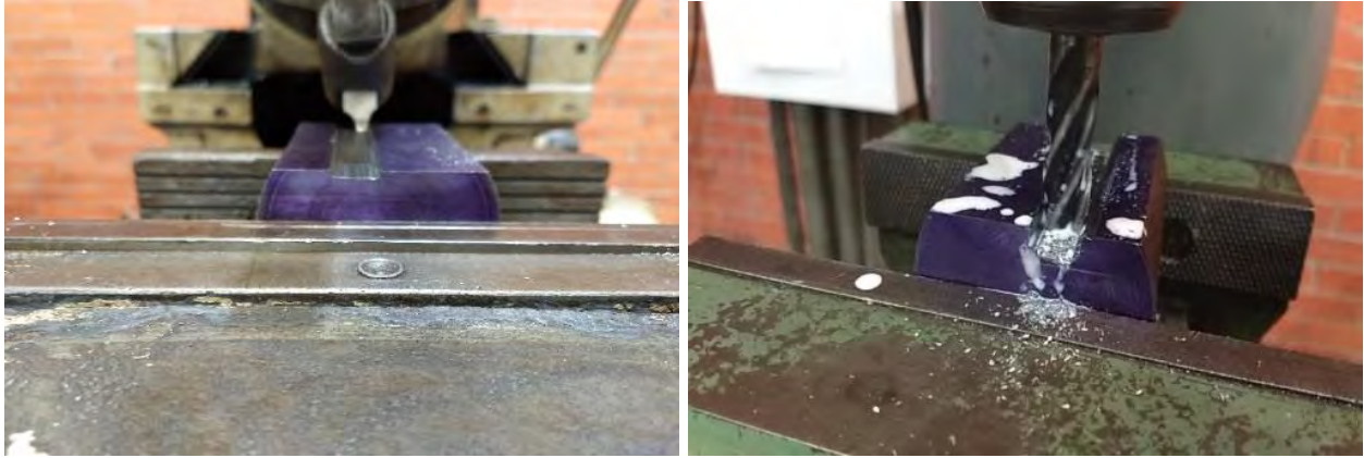
Figura 4.59 Maquinado de ranura inferior para opresor de dados de 19 mm.
