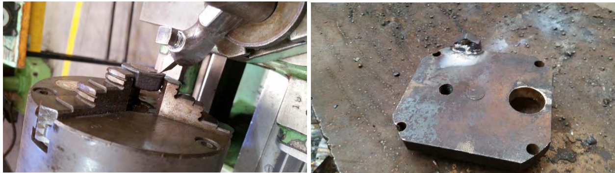
Figura 4.46 Se muestra el maquinado y la soldadura de cabeza de tornillo de 3/4" para nivelar altura de la placa.
