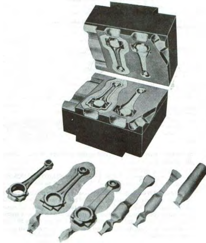
Figura 2.5 Conjunto de dados de forja cerrados con ilustraciones de los pasos sucesivos para forjar una biela. [9]
