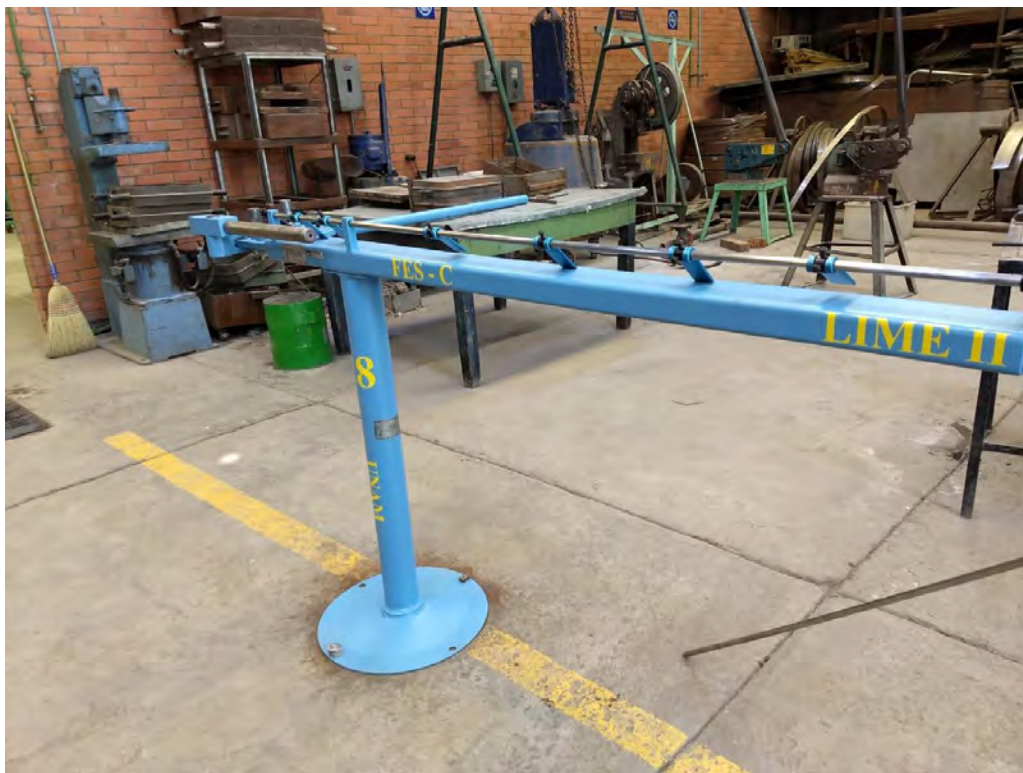
Figura 5.19 Se muestra la dobladora de tubos restaurada en su totalidad.
