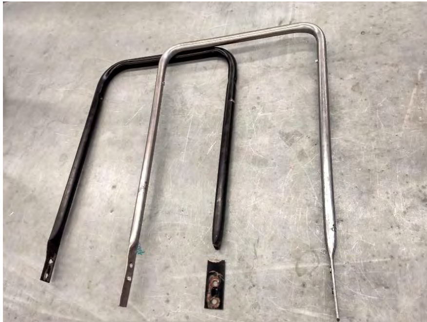
Figura 5.14 Reposición de tubo roto para podadora, refacción elaborada en LIME II Manufactura con la dobladora de tubos recién habilitada.
