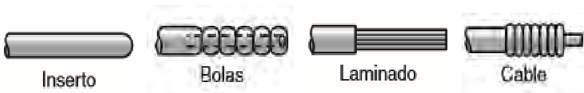
Figura 3.5 La imagen nos muestra la variedad de mandriles que pueden ser utilizados para dobles de tubo. [14]
