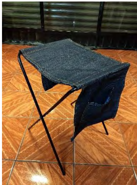
Figura 5.12 Banco plegable elaborado con la dobladora de tubos en LIME II Manufactura.
