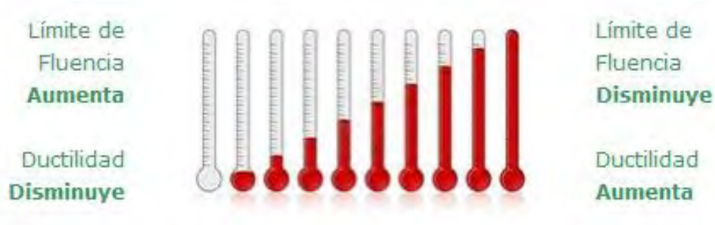
Figura 2.1 Relación de fluencia y ductilidad con respecto a la temperatura. [6]
