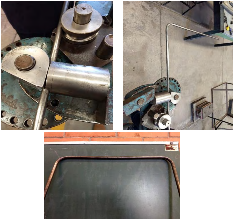
Figura 5.1 Pruebas de curvado a 90° en tubería industrial de 1/2" cal. 18.
