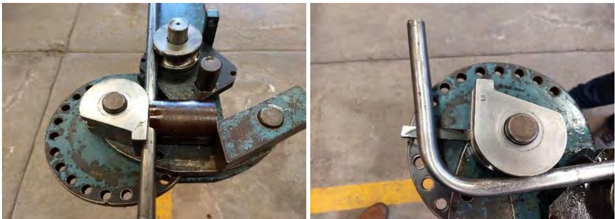
Figura 4.60 Prueba de doblado satisfactoria en tubería industrial de 3/4" con dados de 19 mm.
