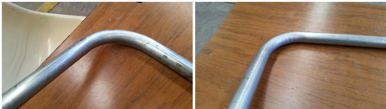
Figura 4.28 Comparación de curvas a 90° realizadas en la dobladora de tubos con dados de 29 mm.
