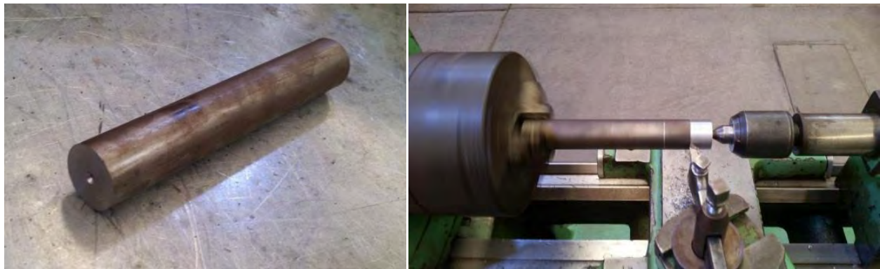
Figura 4.10 En esta figura observamos el cilindrado en torno del dispositivo pecho paloma.
