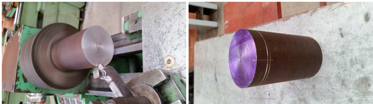
Figura 4.39 Refrentado y trazado de centro para perforación de opresor dados 13 mm.
