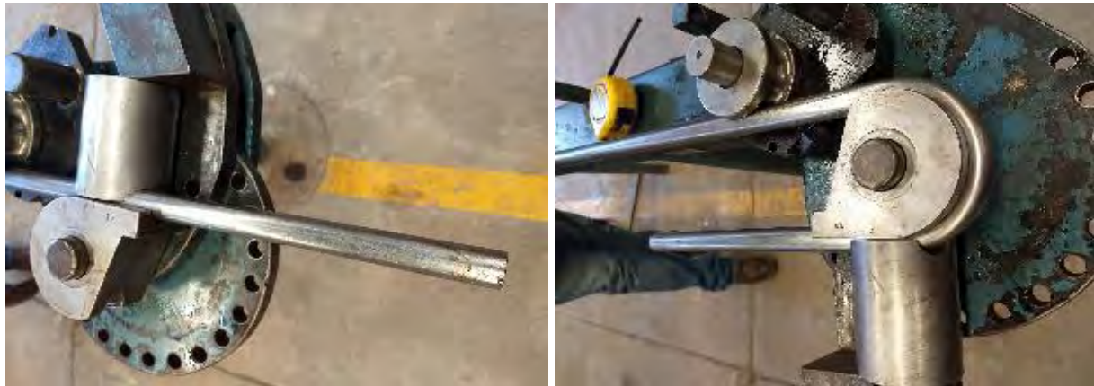
Figura 5.5 Dobleza a 180° en tubería industrial de 3/4" cal. 16 con tubo relleno de arena.
