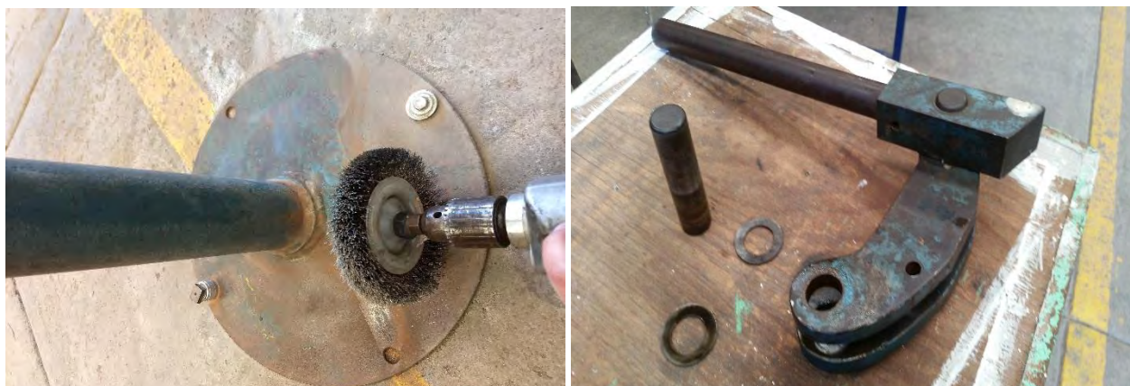
Figura 5.15 Desarmado de componentes de dobladora y remoción de óxido y pintura maltratada.
