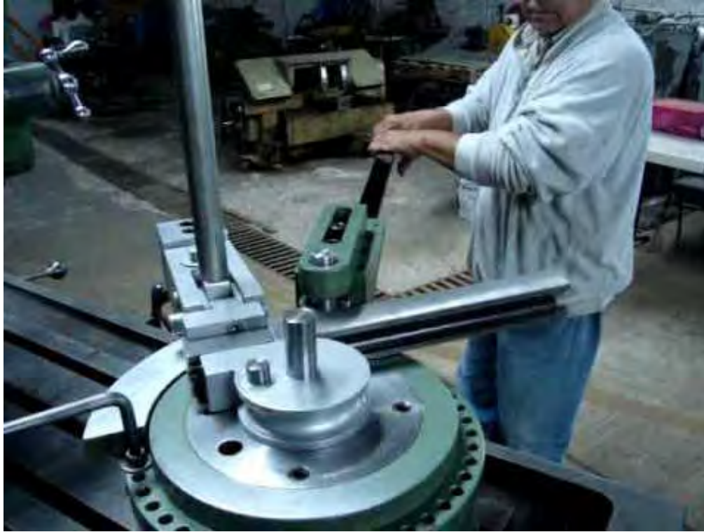
Figura 1.4 Máquina dobladora de tubos por compresión. [2]
