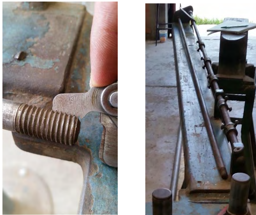
Figura 4.24 Barra para mandril con rosca de \frac{1}{2} " 13 hilos con la que cuenta la dobladora.
