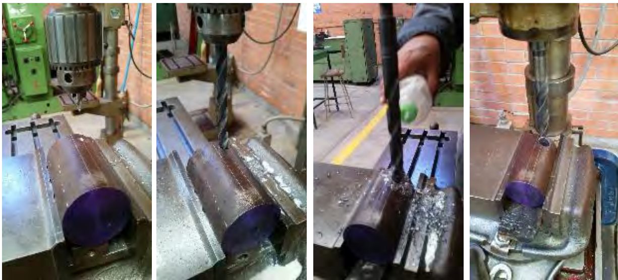
Figura 4.55 Barrenación de opresor para dados 19 mm. escalonando brocas en fresadora y taladro.
