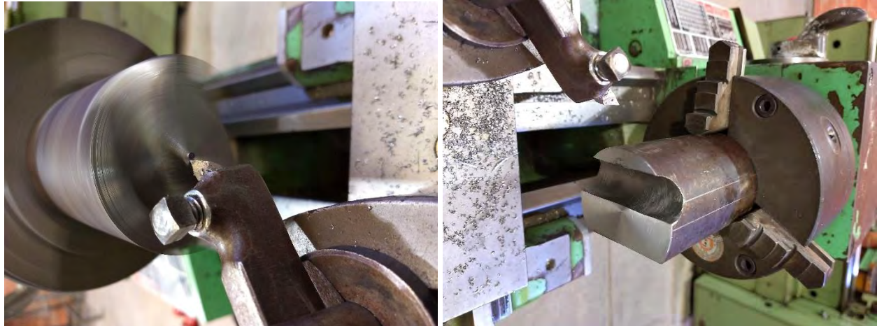
Figura 4.58 Ajuste con refrentado de cara frontal de opresor para dados de 19 mm.
