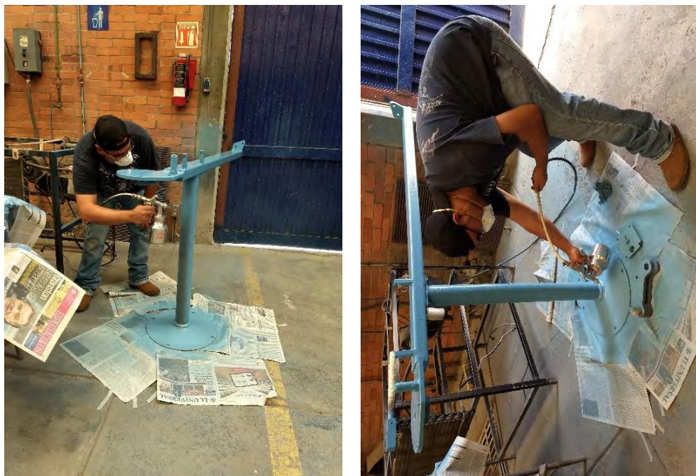
Figura 5.17 Aplicación de baño de pintura a cada parte de la maquina dobladora.
