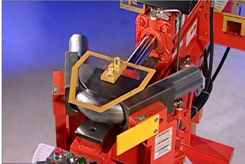
Figura 1.3 Máquina dobladora de tubos por presión de prensa. [2]
