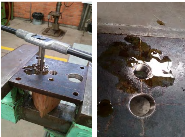
Figura 4.33 Muestra la elaboración de cuerda 5/8" 11 hilos para barra porta polea.
