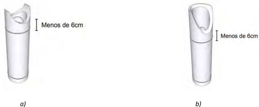
Figura 1.2. Tipo de entalladura para ensamblar bambúes [20]. a) boca de pescado, b) pico de flauta.
