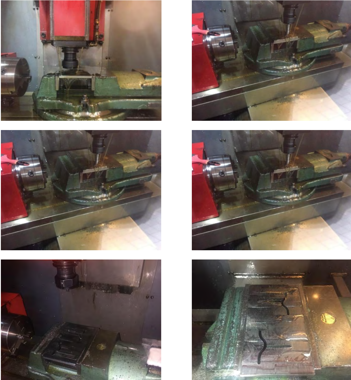
Figura R.3. Fresado de cavidades mediante centro de maquinado EMCO VMC-300.
