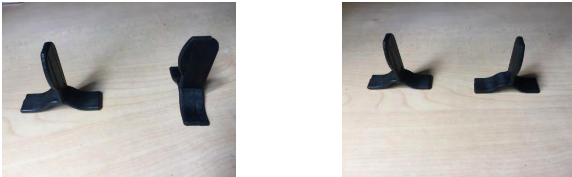
Figura R.9. Prototipos del componente 3 fabricado en Nylon PA66 30% fibra de vidrio.
