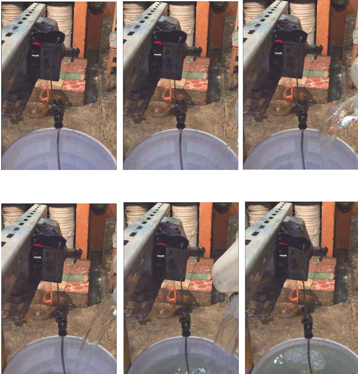
Figura R.12. Etapas de vertido en el contenedor de agua en donde se aprecia el desplazamiento del componente.
