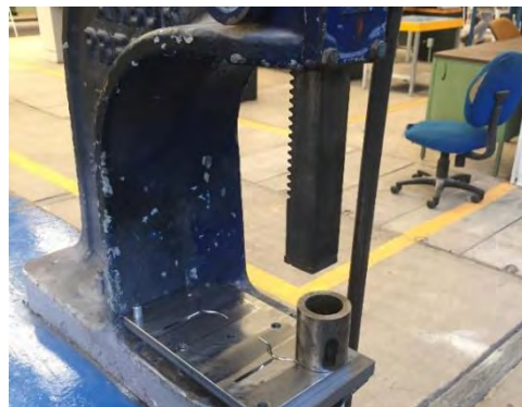
Figura R.4. Torneado de perno y prensado para ajuste por interferencia.
