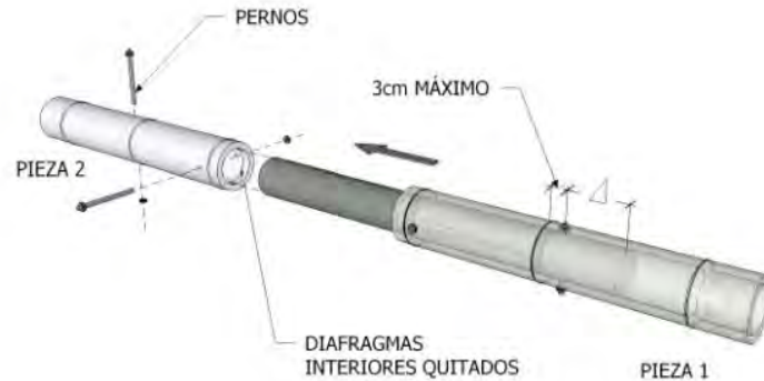
Figura 1.5. Unión longitudinal mediante pernos y cilindro de menor diámetro [20].
