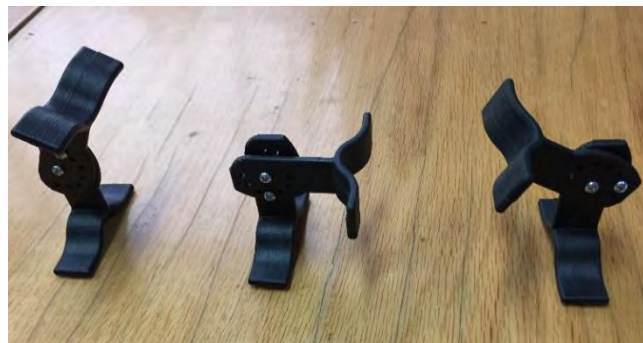
Figura R.10. Ensamble de los prototipos para la fijación de bambú.
