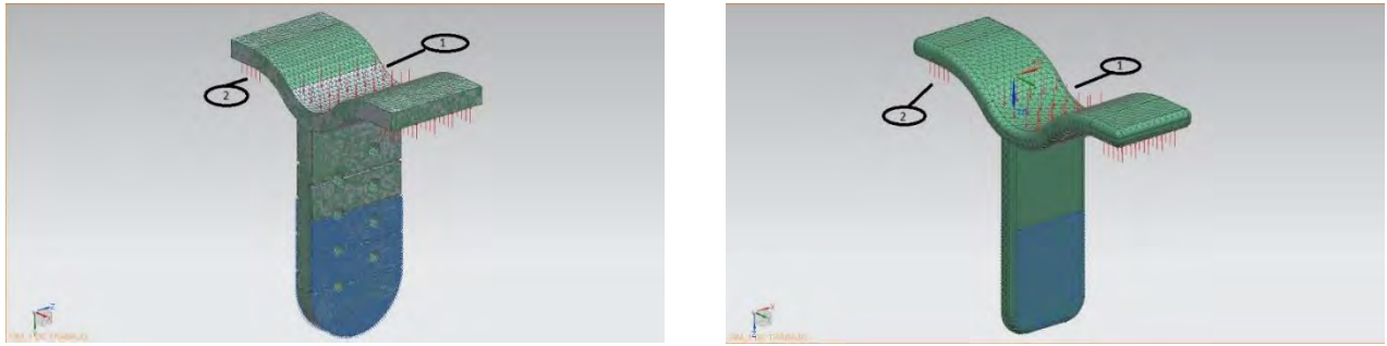
Figura 3.12. Configuración de cargas y restricciones para la pieza 2, el modelo original en el lado izquierdo y el modelo rediseñado en el lado derecho.
