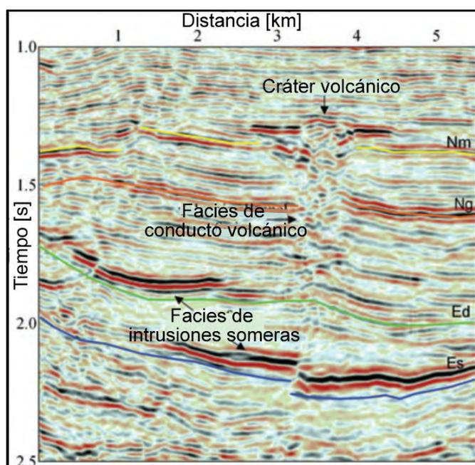
Figura 6. 2 Edificio volcánico típico en la formación en una sección del cubo sísmico en el área (Wu, Liu, Su, & Su, 2010).
