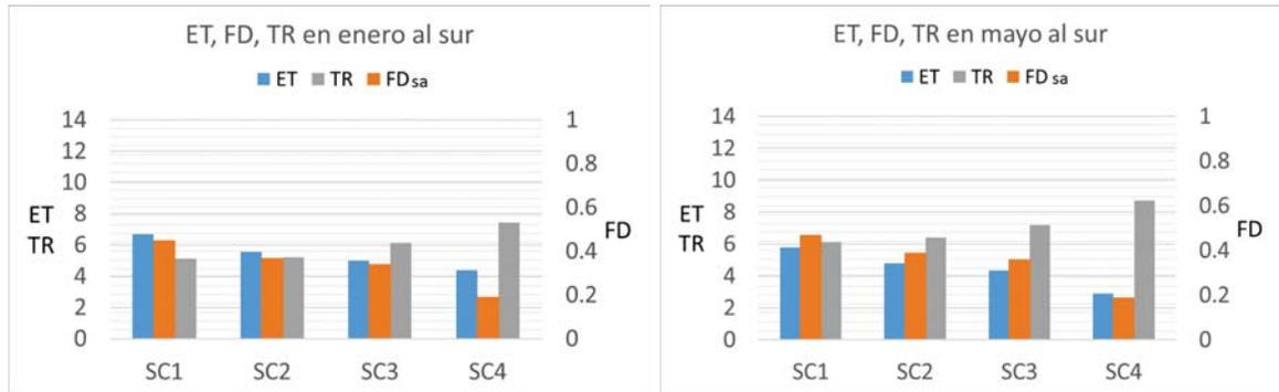
Figura 3-30: Sistemas constructivos al sur en enero y mayo, sin uso de aire acondicionado. ET ( $\text{Wh}/\text{m}^2$  día): energía transmitida. FD: factor de decremento sol-aire. TR ( $h$ ): tiempo de retraso.
