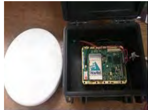
Figura 1-11. Estación y componentes GPS del monitoreo en la C.H La Yesca Fuente: Fotos propias.
