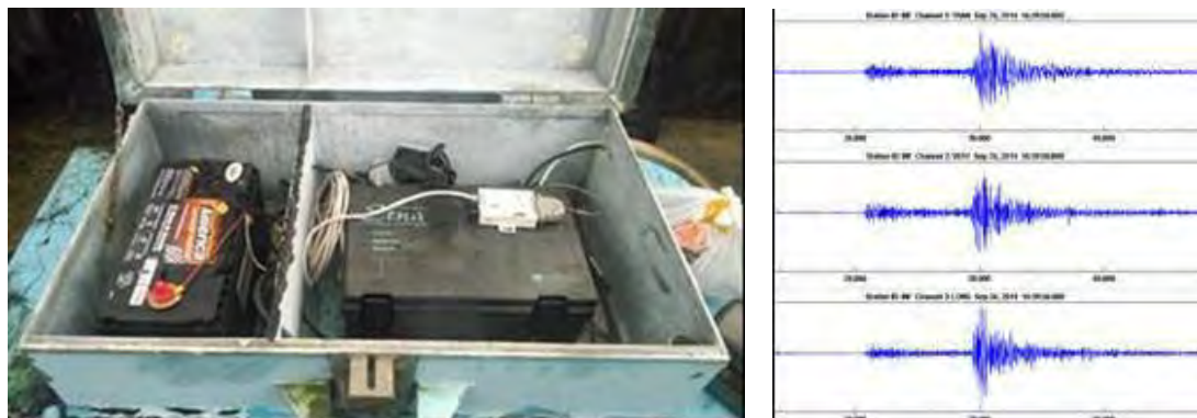
Figura 1-9. Estación acelerográfica y acelerograma Fuente: Foto Original y gráfica propia
