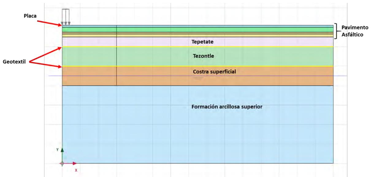
Figura 5.2 Sección geométrica del terraplén de referencia en un análisis Axisimétrico.
