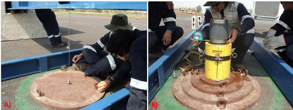
Figura 3.35 A) Colocación de la placa de carga, B) Arreglo de placas, gato hidráulico y celda de carga.
