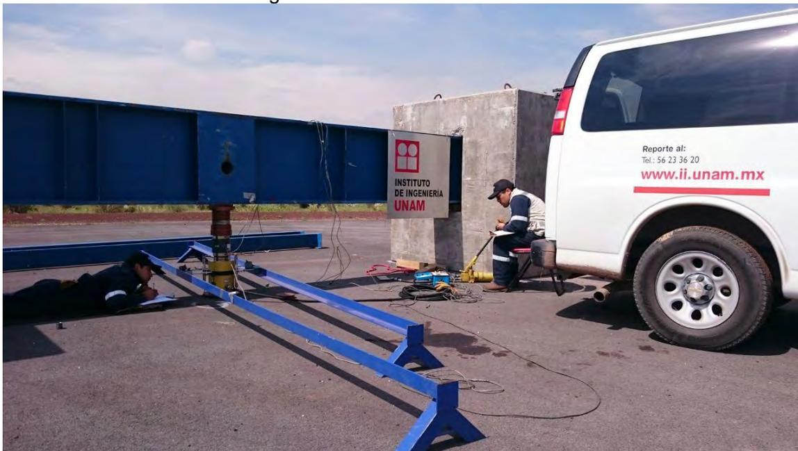
Figura 3.37 Ejecución de las pruebas de placa en los tramos de prueba.
