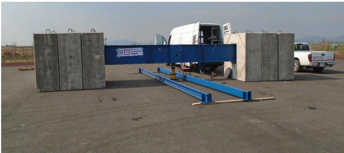
Figura 3.21 Sistema de reacción compuesto por 6 bloques de concreto reforzado y viga de acero.
