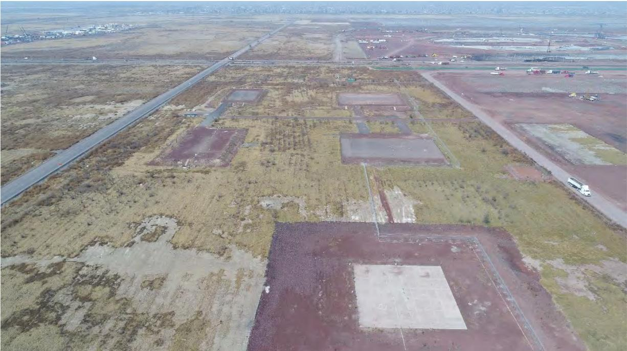
Figura 3.3 Tramos de prueba construidos sobre el suelo del ex Lago de Texcoco (vista hacia el Oeste).
