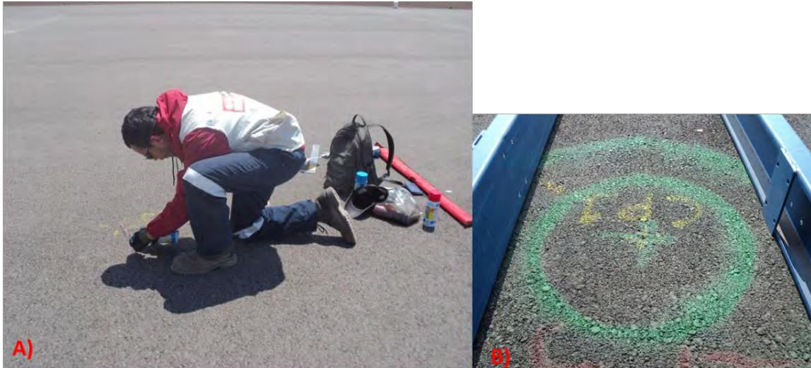
Figura 3.16 a) Ubicación y trazo de los puntos de ensaye, b) Punto de ensaye ubicado sobre la superficie del pavimento
