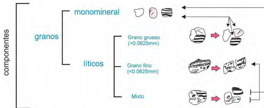
Figura 4.1 Esquema de la clasificación de los componentes detríticos de las areniscas para la metodología del conteo de puntos de Dickinson (modificado de Zuffa, 1985)
