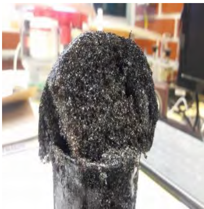
e) Resina polimérica después de un tratamiento térmico de 300^{\circ}\text{C} por 1 hora.
