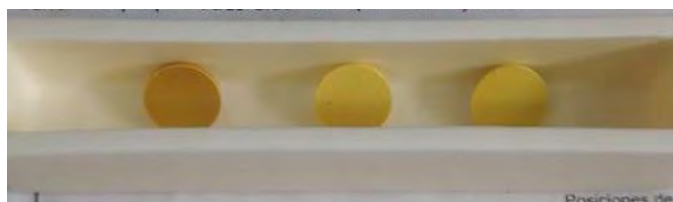
Figura 41. Pastillas cerámicas obtenidas después del tratamiento térmico a 1000°C.
