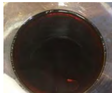
c) Cambio en la coloración de la solución, indicando la formación de la resina polimérica.
