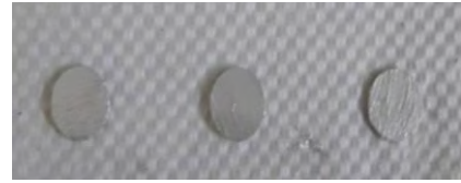
Figura 46. Pastillas cerámicas recubiertas con el electrodo de plata.
