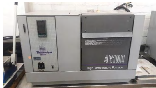
f) Calcinación de resina a 800^{\circ}\text{C} por 2 horas.
