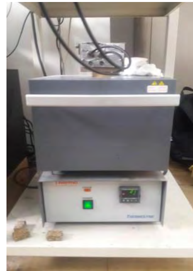
Figura 47. Mufla THERMOLINE acoplada al analizador de impedancias.
