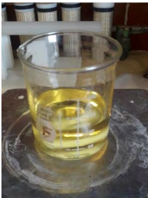
a) Mezcla de cationes \text{Bi}^{3+} , \text{Na}^+ , \text{Ti}^{4+} y \text{Fe}^{3+} en agitación.
