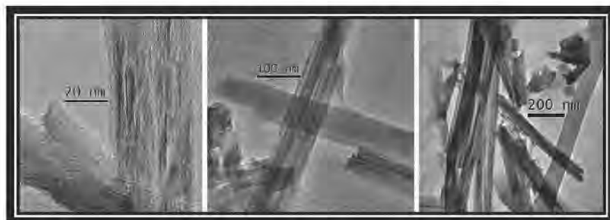
FIGURA 20. Imágenes obtenidas mediante TEM de la muestra del catalizador NaNT1 a diferentes aumentos.
