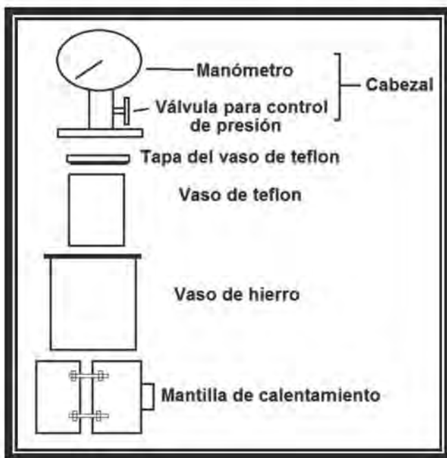
FIGURA 6. Esquema del reactor 1 de la marca Parr de 1L.
