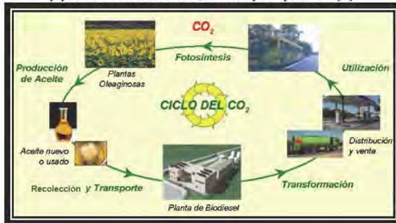
FIGURA 1. Ciclo del dióxido de carbono en el uso y producción de biodiesel, tomado y adaptado de [4].
