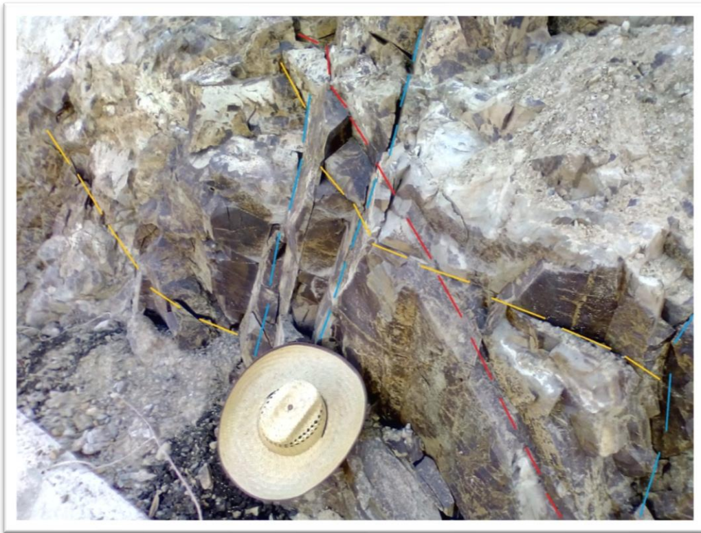
Figura 5.15. Tres direcciones principales de las diaclasas.
