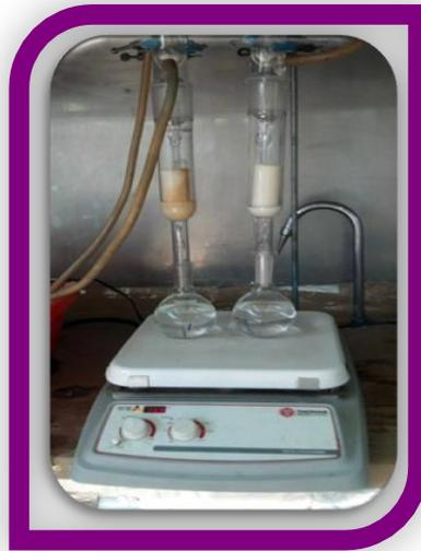
Figura 8. Extracción por el método de Soxhlet.
