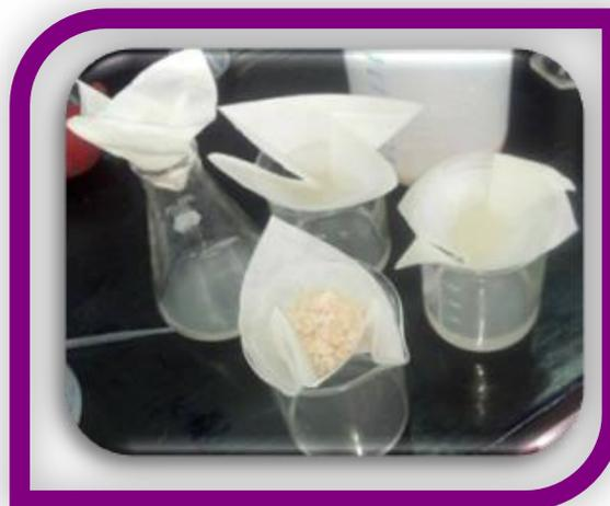
Figura 10. Lavados con hexano y filtración para la obtención de harina.
