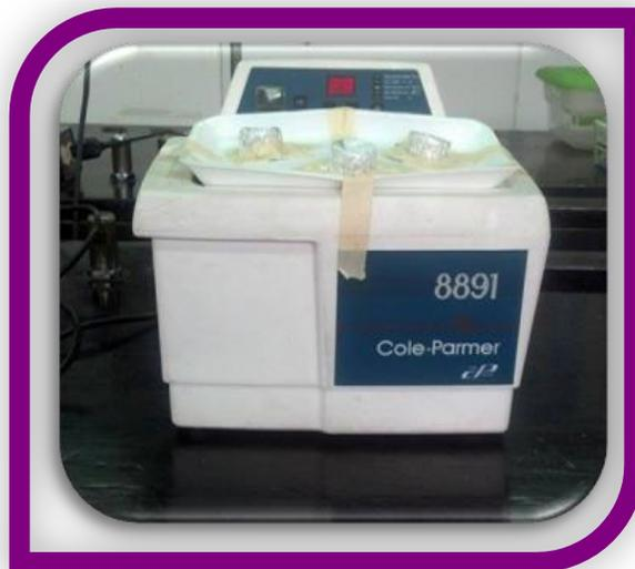
Figura 9. Extracción asistida por ultrasonido con sonicador.
