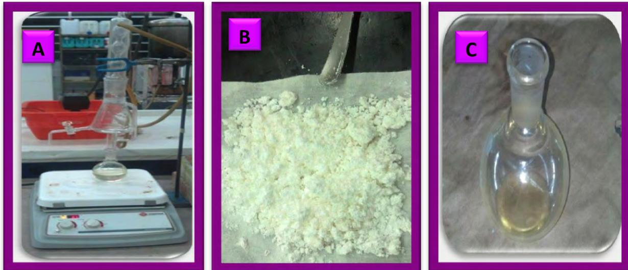
Figura 11. Fraccionamiento de aceite: (A) recuperador de disolvente, (B) fracción estearina, (C) fracción oleína.
