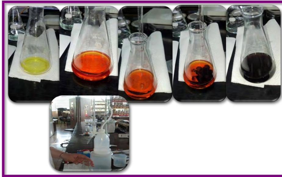
Figura 14. Determinación del índice de Yodo.
