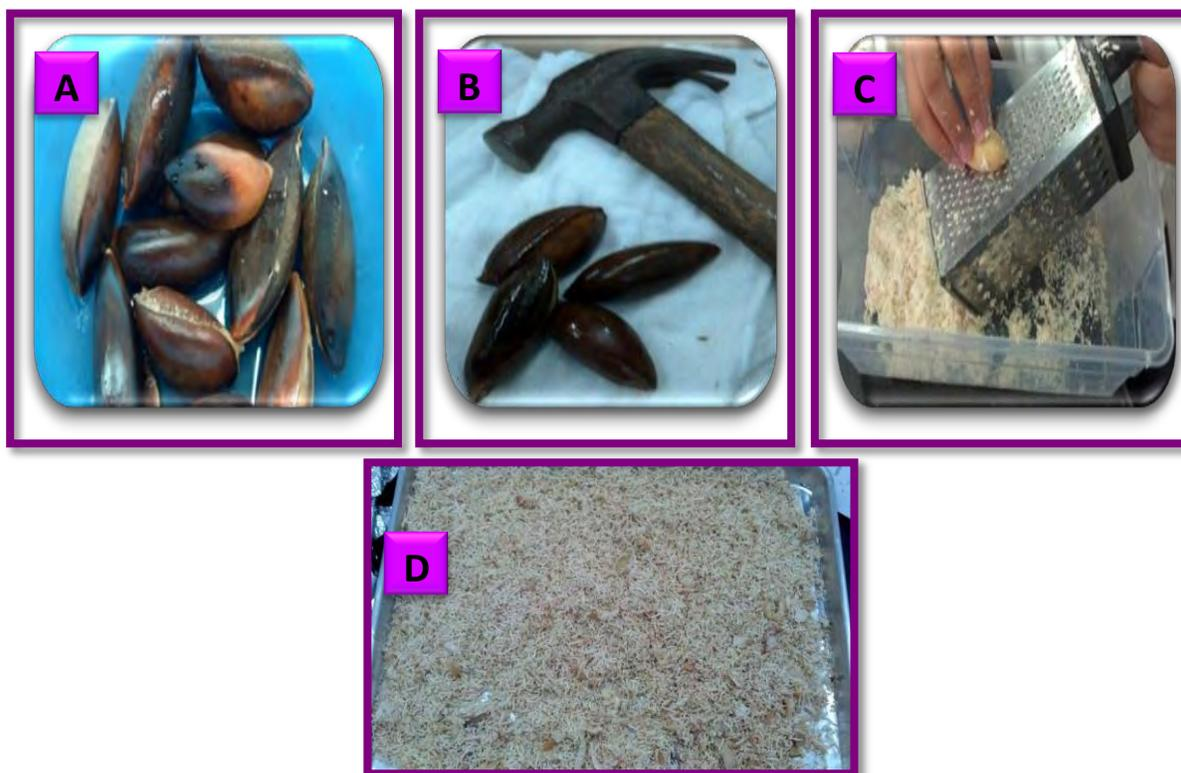
Figura 7. Proceso de obtención de la semilla para la extracción de aceite de mamey A) Lavado del hueso, B) Obtención de la semilla con martillo, C) Reducción del tamaño de partícula, D) Secado de la semilla.
